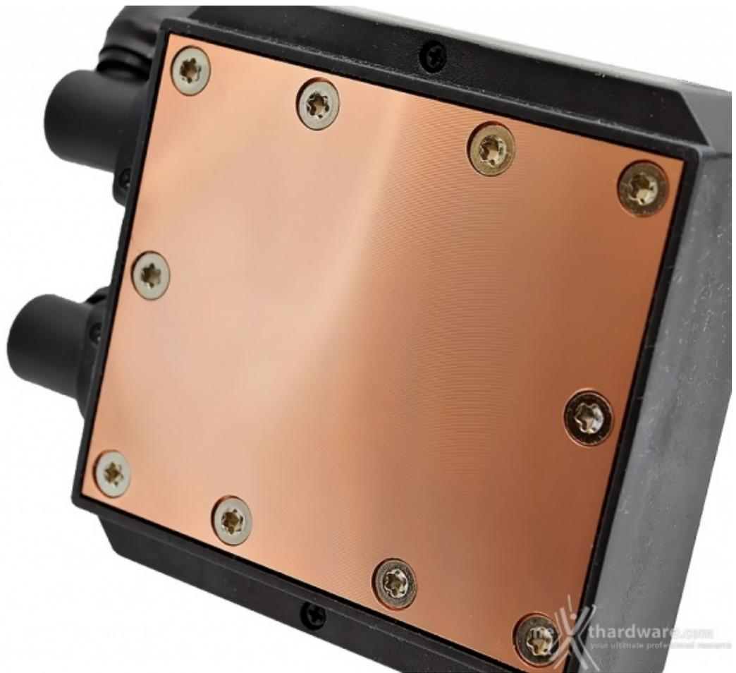
La superficie risulta perfettamente planare e si avvale di una levigatura opaca eseguita in maniera impeccabile.
