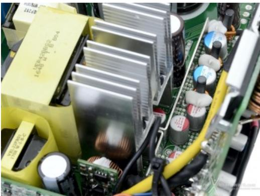
Particolare del dissipatore dedicato al raffreddamento dei regolatori d'uscita. Nell'immagine si notano anche le guide metalliche che si occupano di veicolare la corrente e diversi condensatori allo stato solido.
