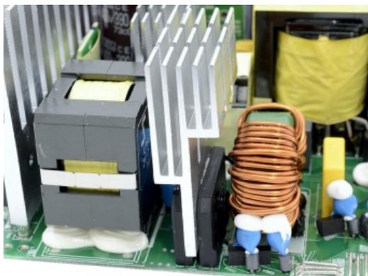
Particolare del doppio ponte raddrizzatore dissipato.
