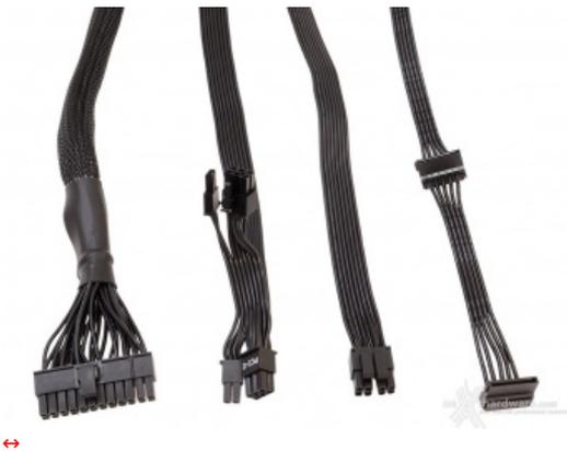
Lo sleaving è stato mantenuto solo per il cavo ATX, mentre per le restanti tipologie si è fatto ricorso ai cavi piatti. Sebbene possano sembrare meno gradevoli alla vista, questi ultimi garantiscono in fase di montaggio un più ampio margine di manovra, soprattutto nei case meno spaziosi.
