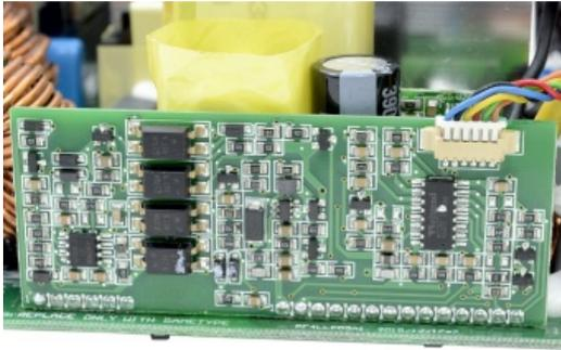
Particolare del chip preposto ai sistemi di protezione.
