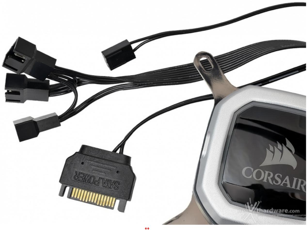
L'alimentazione è affidata ad un connettore SATA POWER che si occuperà di garantire i 12V necessari al corretto funzionamento della pompa, dei LED RGB e delle ventole (se collegate allo sdoppiatore).
