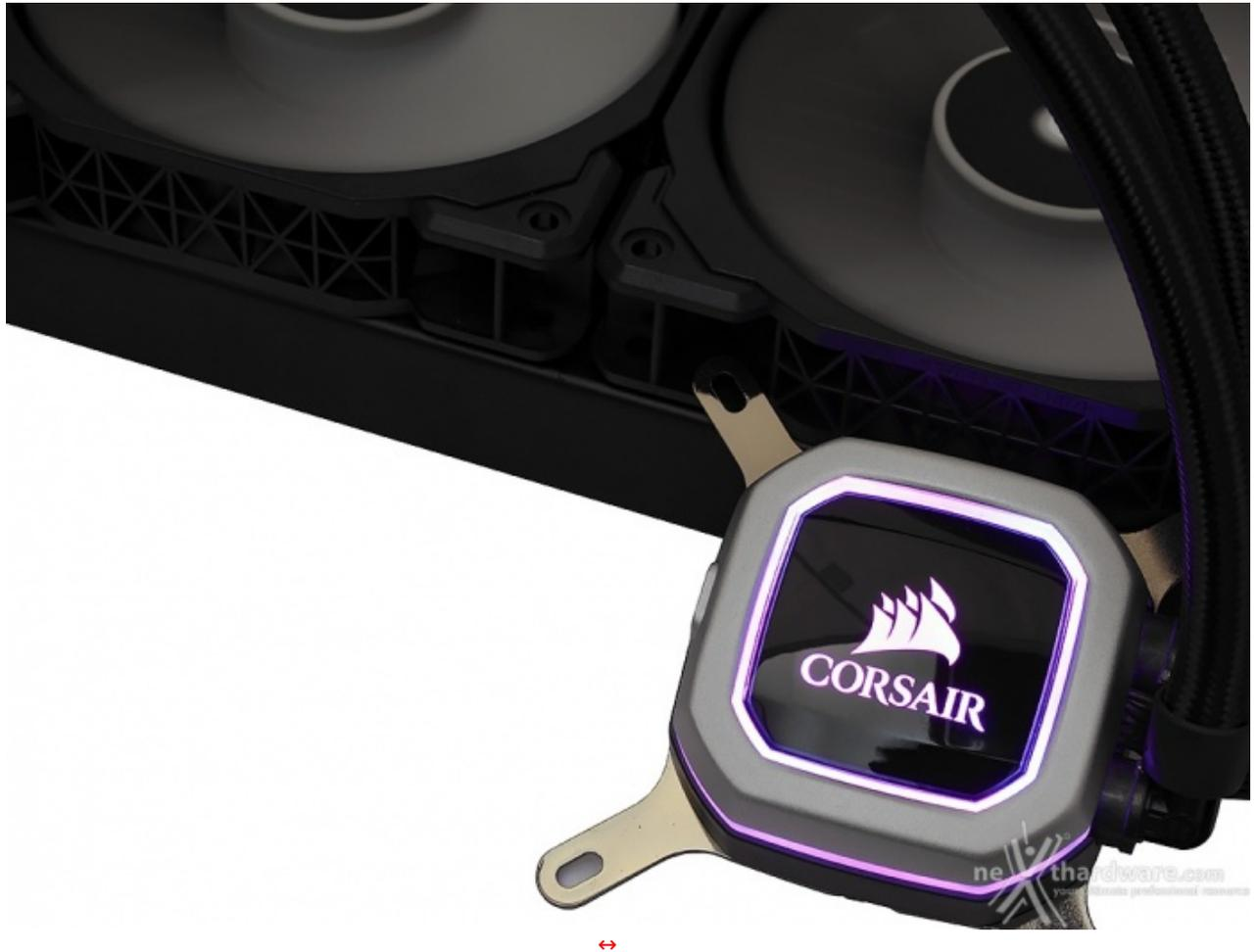
Una volta collegato il connettore SATA POWER, i LED RGB installati all'interno della struttura illumineranno la banda superiore, quella laterale e il logo, di un'intensa luce (a default nella modalità Color-Shift).
