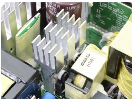
Particolare dei quattro transistor di switching in configurazione full-bridge e relativo dissipatore dedicato.
