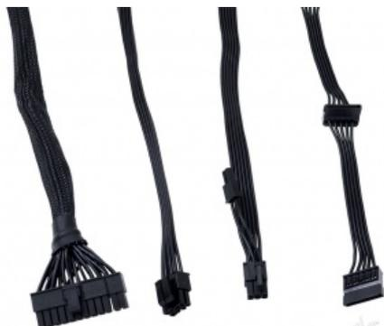
Lo sleaving è praticamente assente, fatta eccezione per il cavo ATX, unico ad essere rivestito sulla serie Titanium.
