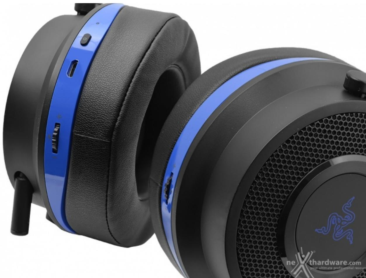
Sono inoltre presenti, sul lato sinistro, il connettore Micro-USB per la ricarica della batteria integrata, il pulsante di accensione/spegnimento ed il relativo LED di stato.
