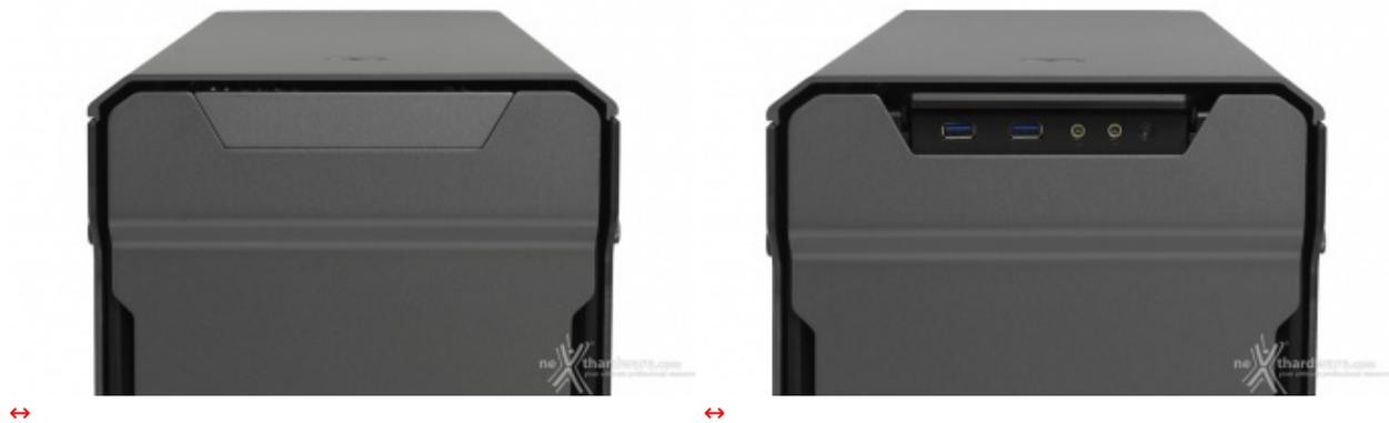
Nei pressi del bordo superiore è posizionato un piccolo sportellino che nasconde il pulsante per la gestione del sistema di illuminazione, due jack HD Audio per cuffie e microfono e due sole USB 3.1 Gen1.
