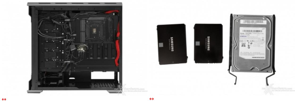
Successivamente abbiamo rivolto la nostra attenzione al retro del piatto mainboard dove, sugli appositi supporti, abbiamo montato i due SSD della Samsung.
