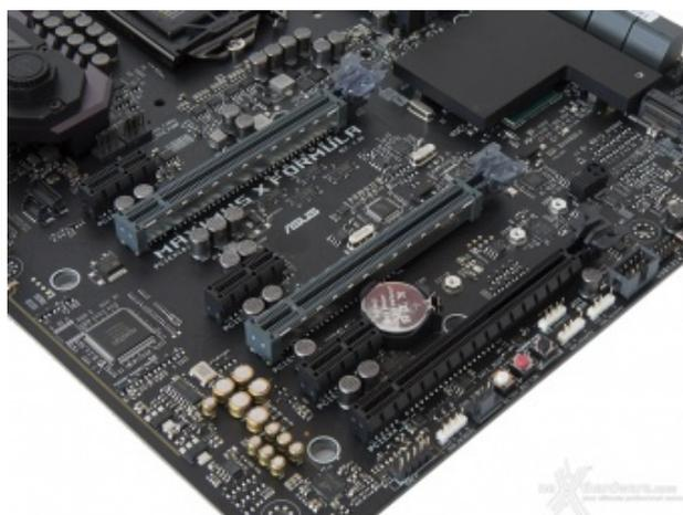
Nelle foto in alto possiamo osservare la dotazione di slot PCI-E, tutti con connessione di tipo 3.0, comprendente tre x1 ed altri tre con velocità pari a, rispettivamente, x16, x8 e x4.
