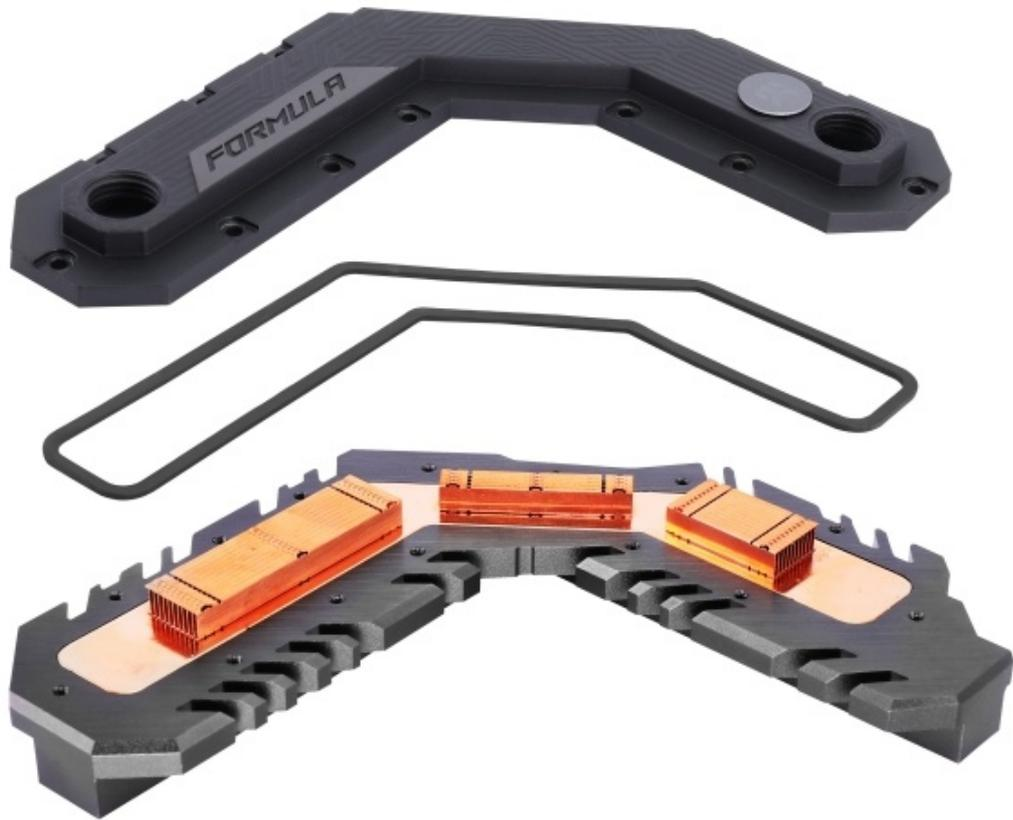
Come potete osservare, quest'ultimo è composto da una base in rame che percorre l'intero dissipatore, un sistema di canalizzazione diviso in tre blocchi dello stesso materiale ed un top in alluminio dotato di due fori filettati G1/4" compatibili con i raccordi utilizzati nella maggior parte degli impianti a liquido.
