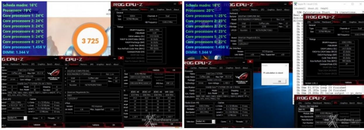
**Test massima frequenza CPU Cache - 5100MHz**
