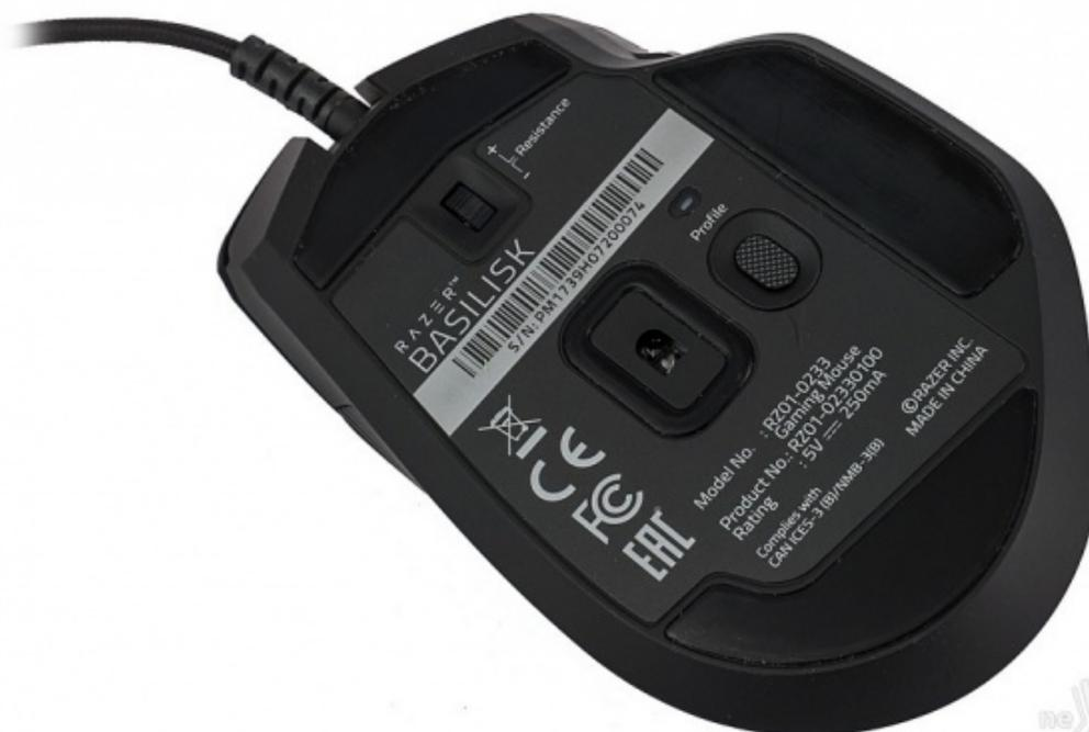
La disposizione dei padsurfer in teflon è ampia come nella maggior parte degli ultimi modelli di casa Razer, con un bordo "stabilizzatore" attorno all'apertura del sensore ottico 5G da 16000 DPI massimi.
