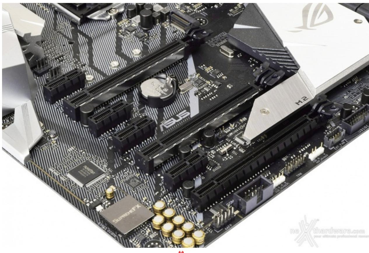
Nelle foto in alto possiamo osservare tutta la dotazione di slot PCI Express comprendente quattro PCIe 3.0 x1 ed altri tre PCIe 3.0 x16 funzionanti rispettivamente in modalità x16, x8 e x4.
