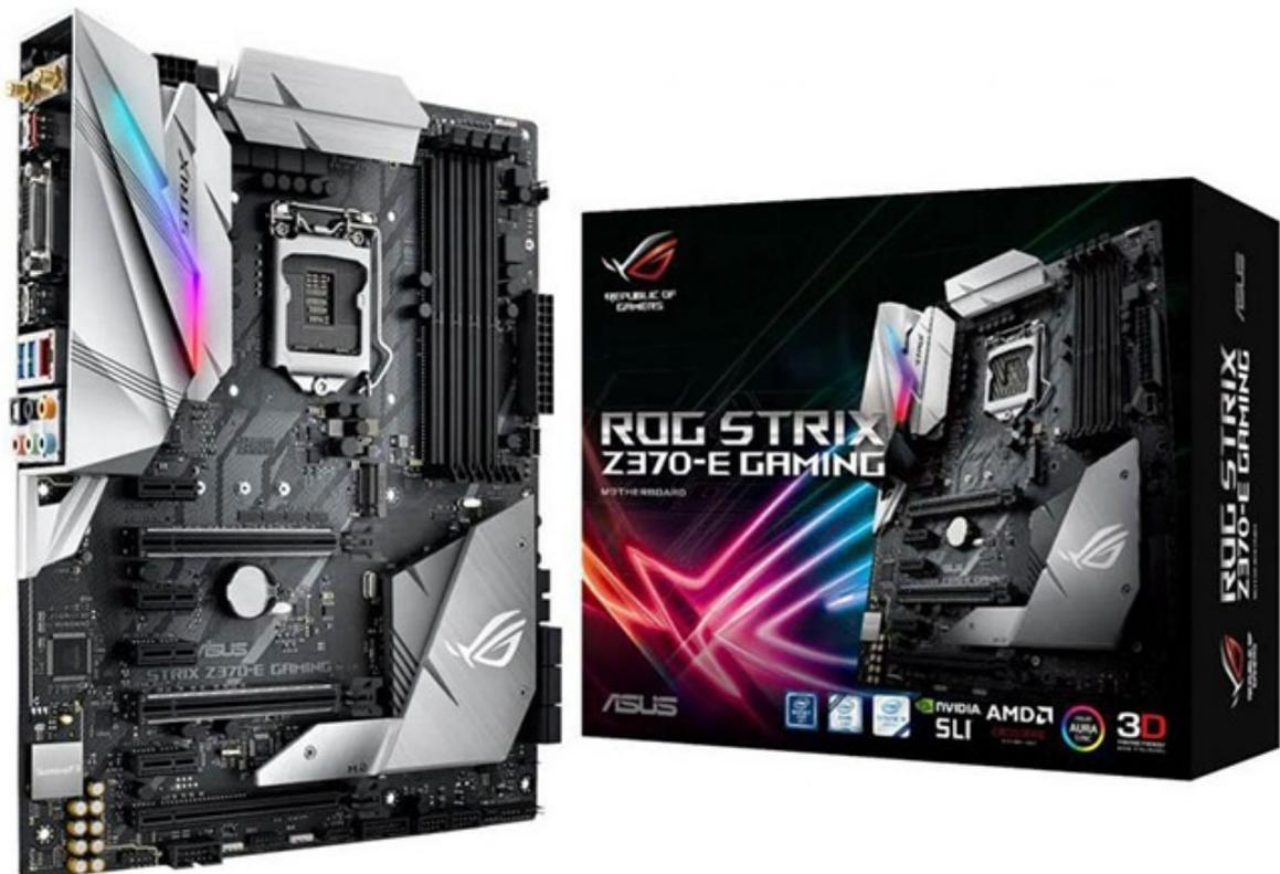
Sotto il profilo della connettività la scheda offre sei porte SATA III, due USB 3.1 Gen1, due USB 3.1 Gen2, Gigabit Ethernet, Wi-Fi dual band, Bluetooth 4.2 e due connettori M.2 PCIe 3.0 x4.
