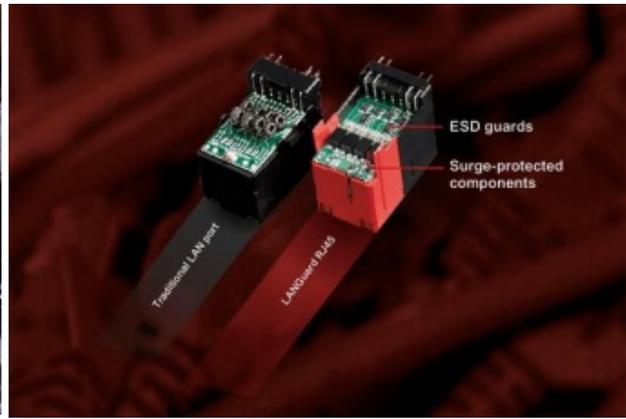
Infine, abbiamo la tecnologia LANGuard, ovvero un particolare connettore di rete progettato per offrire una protezione 1,9 volte superiore rispetto alla norma nei confronti degli effetti dell'elettricità statica e fino a 2,5 volte (15kV) contro fulmini e sovratensioni che possono propagarsi sulla rete.
