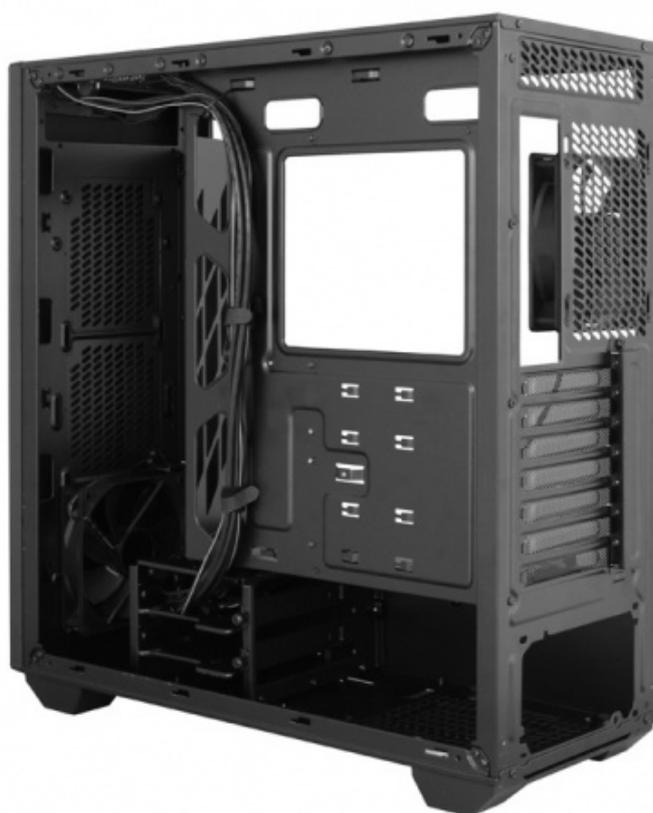
Una volta rimossa la paratia destra, possiamo scorgere nello scomparto inferiore un cestello in grado di contenere due drive da 2,5" o 3,5".
