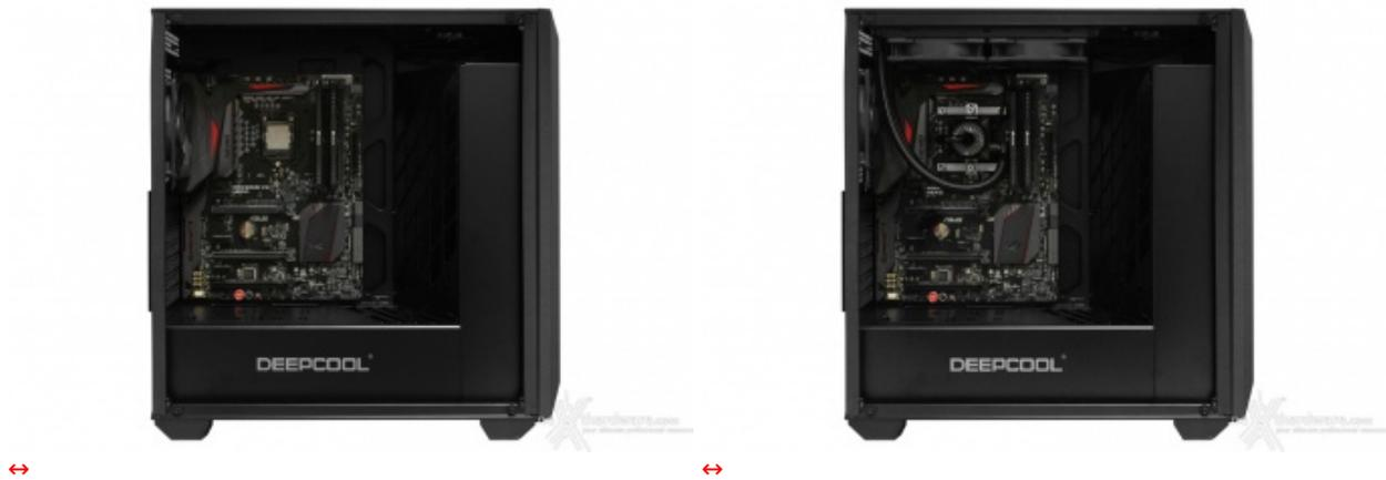
Per prima cosa abbiamo installato la scheda madre in formato ATX abbinata al sistema di raffreddamento All-in-One con radiatore da 240mm montato sul top del case.
