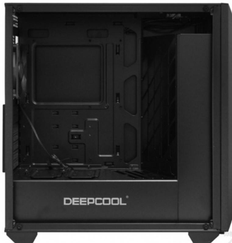
Il vassoio per la scheda madre dispone di un ampio scasso in corrispondenza della zona dissipatore, per permettere la manutenzione e l'installazione di quest'ultimo senza dover necessariamente smontare il resto dei componenti.
