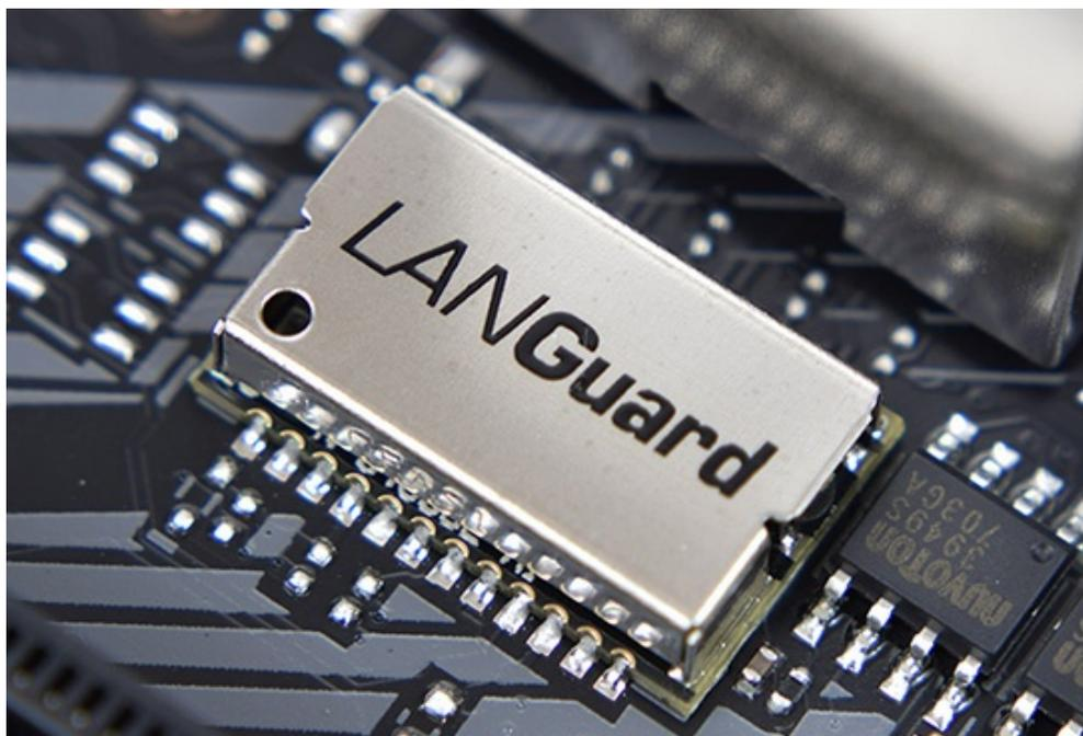
Infine, abbiamo la funzione LANGuard, ovvero un particolare connettore di rete progettato per offrire una protezione 1,9 volte superiore rispetto alla norma nei confronti degli effetti dell'elettricità statica e fino a 2,5 volte (15kV) contro fulmini e sovratensioni che possono propagarsi sulla rete.
