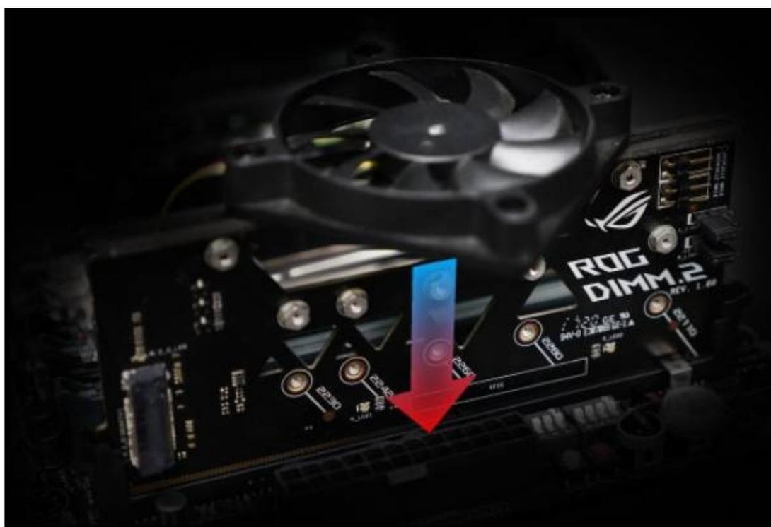
Grazie ai supporti in dotazione, è possibile inoltre installare una ventola opzionale da 50mm sulla sommità delle DIMM.2 Card, in maniera tale da ridurre la temperatura d'esercizio degli SSD, che potrà essere monitorata semplicemente collegando gli appositi cavi ai due header situati sull'estremità superiore destra della scheda.
