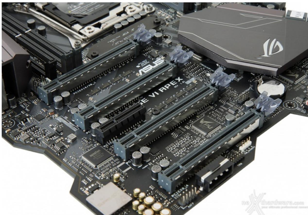
Nella foto in alto possiamo osservare la dotazione di slot PCIe, tutti con connessione di tipo 3.0, comprendente uno slot x4 e quattro a lunghezza intera di tipo SafeSlot con velocità massima pari, rispettivamente, a x16, x8, x8, x8.
