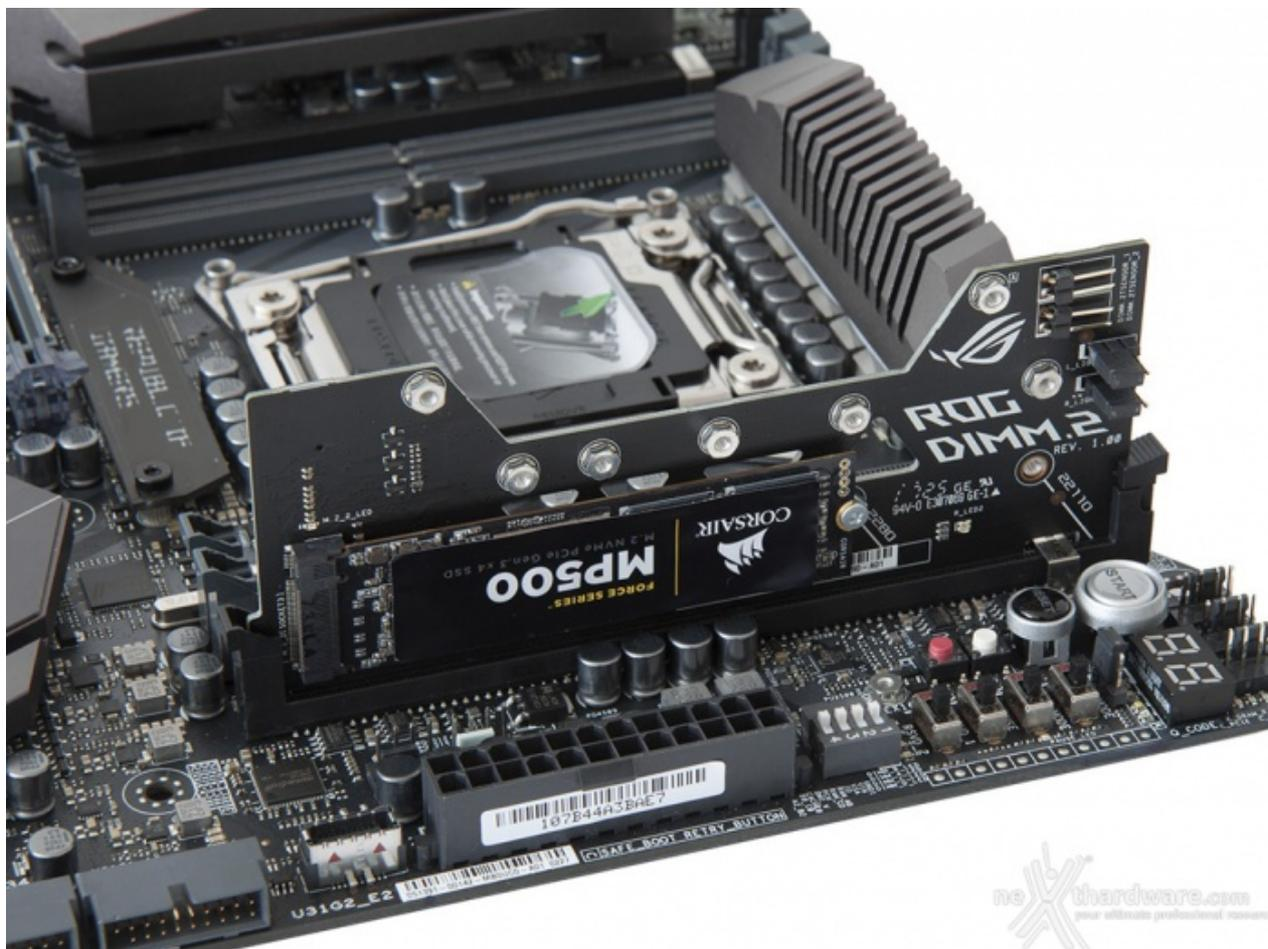
Il montaggio delle DIMM.2 Card, al pari di quello dei moduli RAM, è estremamente semplice e prevede l'utilizzo delle viti in bundle unicamente per fissare i drive M.2.
