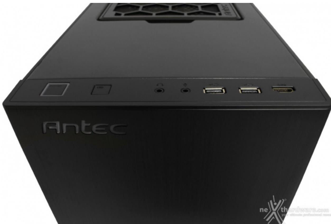
Lo stesso comprende il pulsante di accensione con LED di stato, un pulsante per il controllo del sistema di illuminazione RGB, i jack HD Audio per cuffie e microfono, due porte USB 3.0 ed una porta HDMI per semplificare l'utilizzo di dispositivi dediti alla realtà virtuale.
