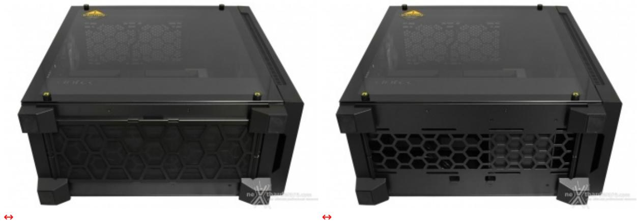
Quest'ultimo, se posizionato con la ventola in basso, potrà attingere aria fresca direttamente tramite l'apposita griglia che percorre tutta la base del case e che, per non permettere l'entrata di polvere, è protetta da un ampio filtro antipolvere estraibile dal lato sinistro.
