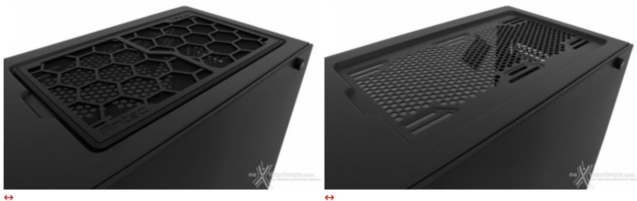
Poco più dietro, sul freddo acciaio, vi è un supporto per due ventole da 120 o 140mm coperto da un filtro antipolvere, anch'esso dotato di calamite, facilmente removibile e dal design molto curato.
