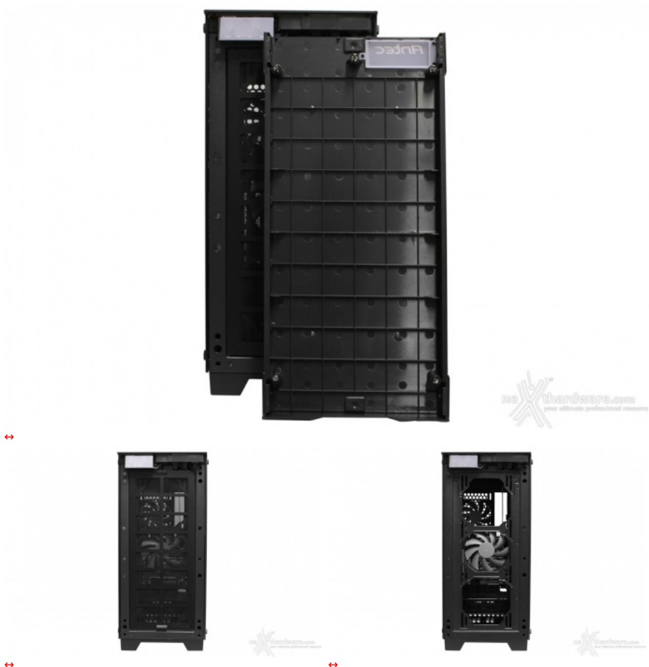
L'intero frontale può essere facilmente rimosso dandoci accesso ad un ampio filtro calamitato posto a protezione del supporto per tre ventole da 120mm, di cui una installata di serie, o due da 140mm.
