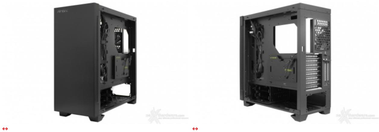
Rimuovendo il pannello destro possiamo analizzare il retro del piatto mainboard che risulta estremamente pulito, soprattutto grazie all'assenza di feritoie e alla presenza di appositi ganci fermacavo.
