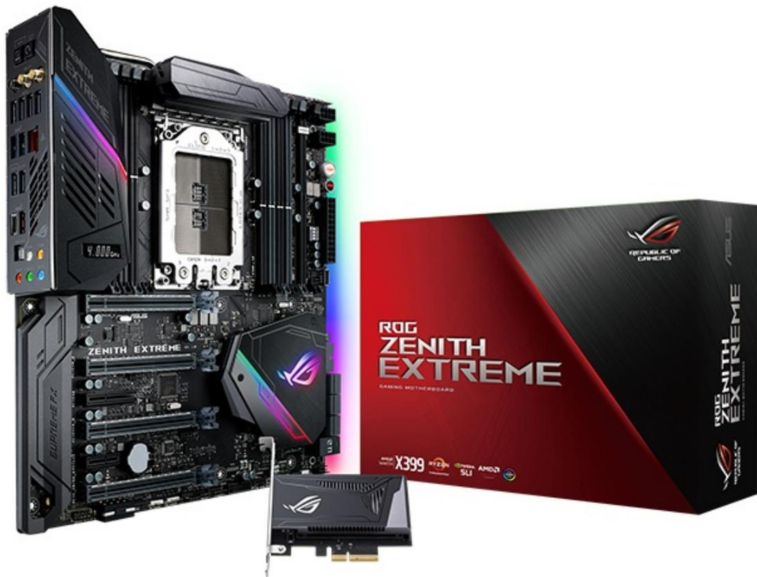
La ROG ZENITH EXTREME, questo il nome della nuova top di gamma AMD targata ROG, si presenta con un fattore di forma E-ATX, è alimentata da ben due connettori EPS a 8 pin ed un ATX 24 pin, è dotata di un circuito VRM DIGI+ a 8 fasi e dispone di otto DIMM per ospitare sino a 128GB di RAM DDR4 in modalità quad channel con frequenza massima di 3600MHz (OC).
