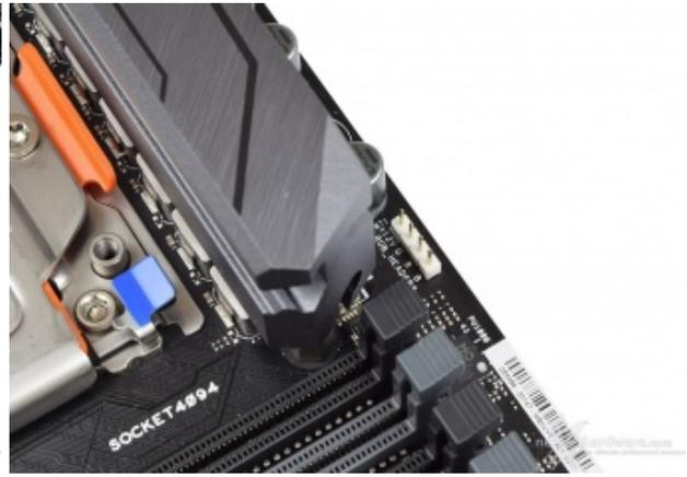
La ASUS ROG ZENITH EXTREME è dotata di tre header per il sistema di illuminazione AURA, su due dei quali potranno essere collegate strisce a LED RGB del tipo 5050, acquistabili separatamente, per una lunghezza massima di due metri ciascuna.
