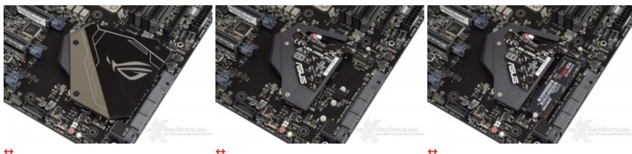
Il primo connettore, denominato M.2\_1, si trova sotto il dissipatore del nuovo FCH e supporta connessioni PCIe 3.0 x4 e SATA III per SSD con lunghezza compresa tra 42 e 80mm.
