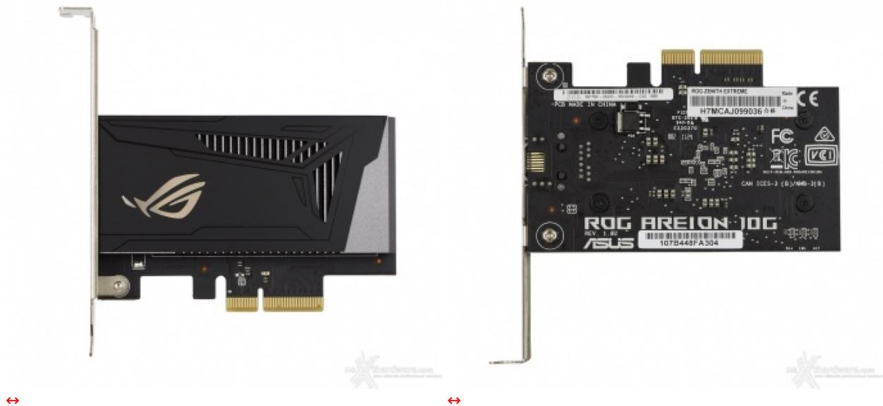
Il produttore, traendo ispirazione dal mitologico cavallo dalla leggendaria velocità, ha creato la ROG AREION 10G, una scheda di rete PCIe 3.0 x4 in grado di raggiungere una velocità di connessione di circa 10 Gbps pur garantendo la compatibilità con le più lente connessioni 5G, 2,5G e 100 Mbps.
