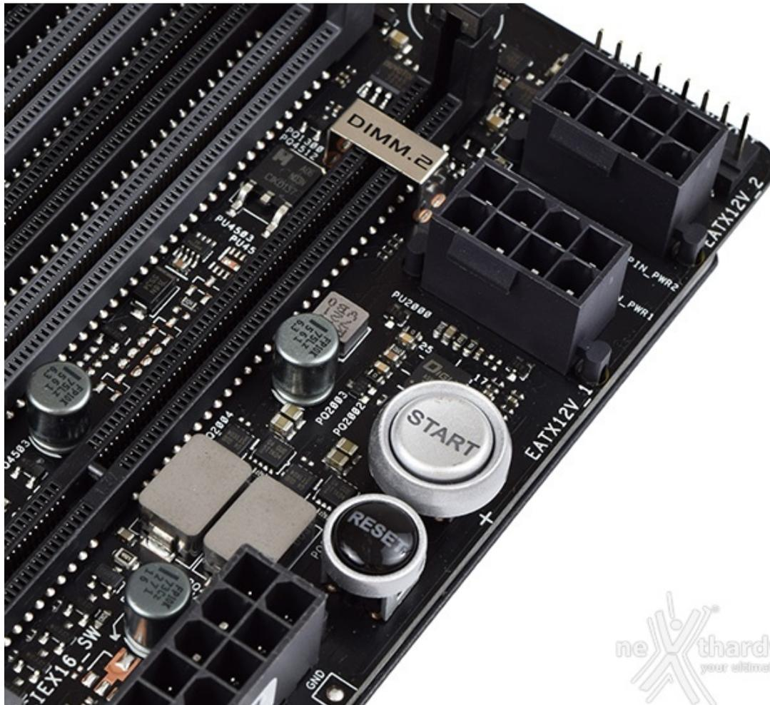
Nell'angolo in alto a destra, sotto i due massicci connettori di alimentazione EPS 8-pin, troviamo i due classici pulsanti di Start e Reset provvisti di retroilluminazione per una più facile individuazione in condizioni di scarsa luminosità .
