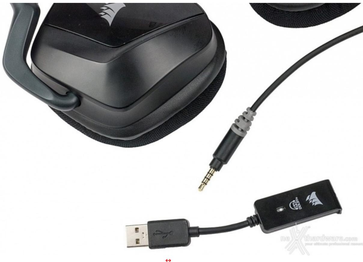
Il cavo, di tipo analogico, termina in un connettore Jack 3,5mm quadripolare, ovvero in grado di trasportare contemporaneamente un segnale stereo e l'input del microfono: tale connettore è utilizzato dai joypad Xbox e PS4 dotati di uscita/entrata Jack, nonché da vari dispositivi mobile, ma non dal PC, dove lo standard è il connettore Jack tripolare per l'audio stereo separato da quello adibito all'input del microfono.
