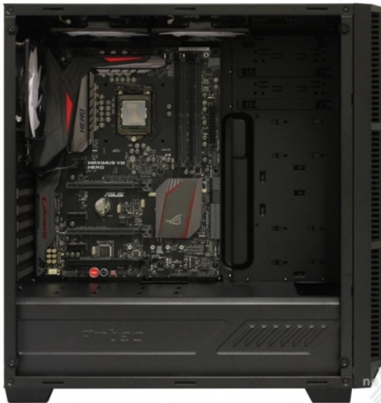
Il montaggio della mainboard si è rivelato estremamente semplice dato che l'ampio spazio a disposizione consente di muoversi liberamente e l'elemento verticale per il passaggio dei cavi, anziché creare intoppi, è servito da guida per l'installazione.
