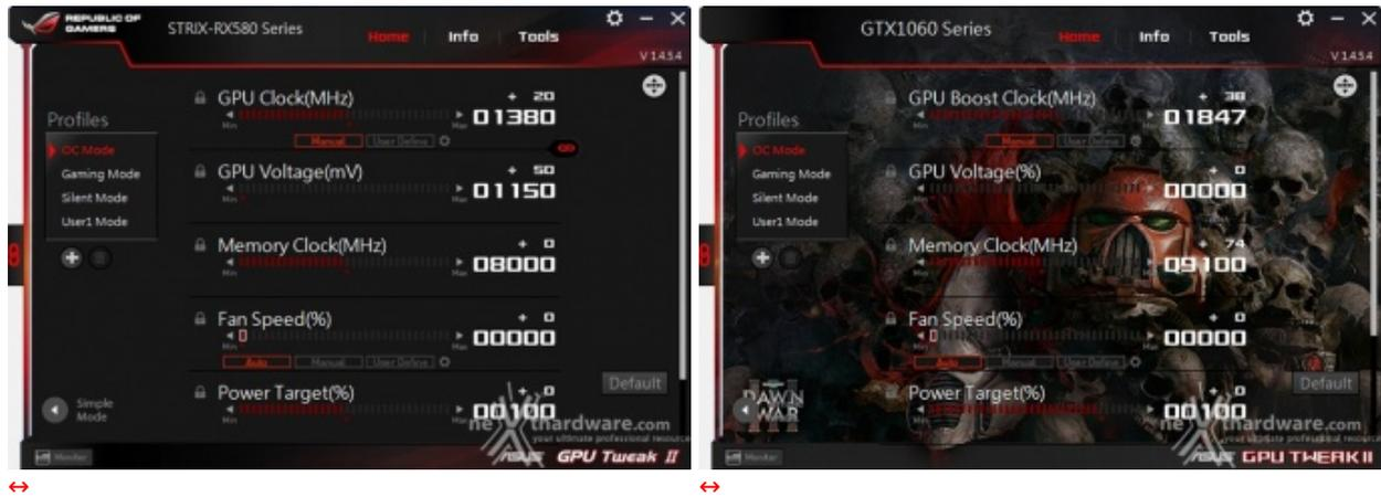
In questa sessione di test ci siamo avvalsi di GPU Tweak II di ASUS, in versione 1.4.5.4, sia per modificare la velocità di clock di base che i parametri di assorbimento energetico.
