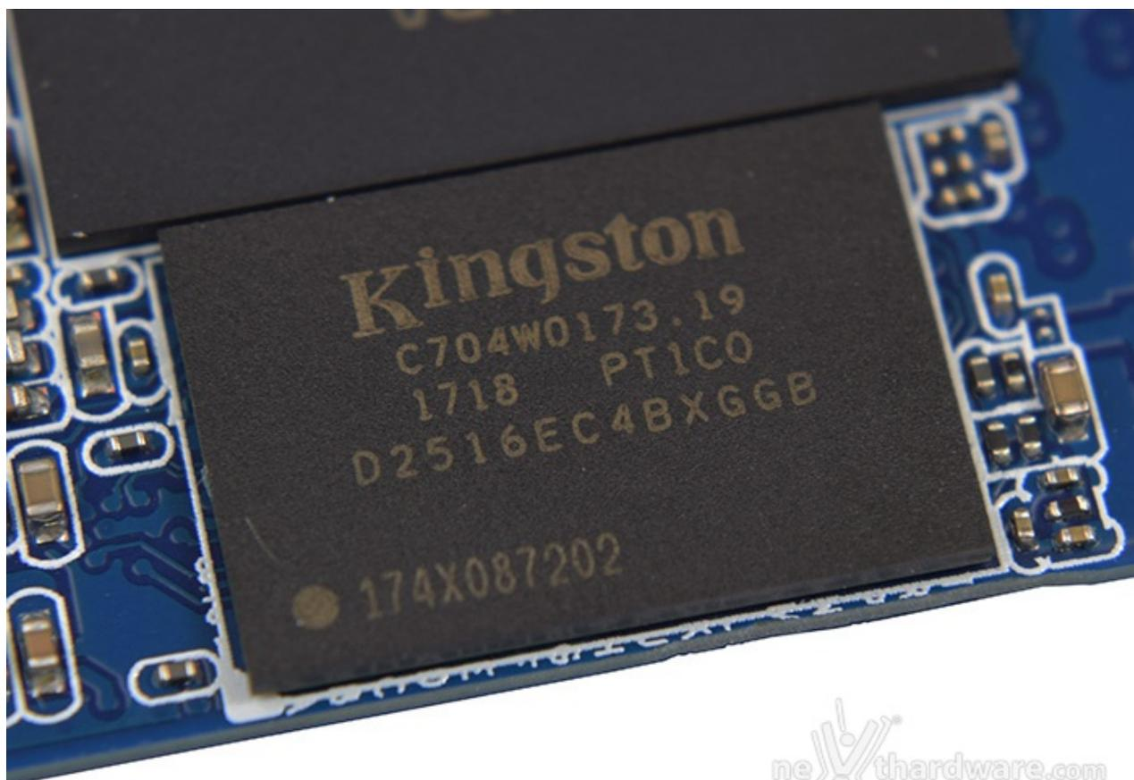
I due chip prodotti da Kingston per la cache dei dati sono di tipo DDR3L operanti a 1600MHz ed aventi una capacità di 512MB ognuno.
