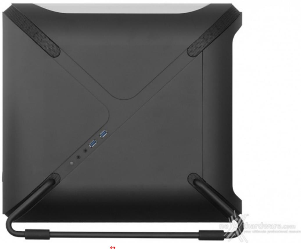
Sul lato destro sono posizionati il pulsante di reset, il LED di stato dei drive, due connettori HD AUDIO e due porte USB 3.0.
