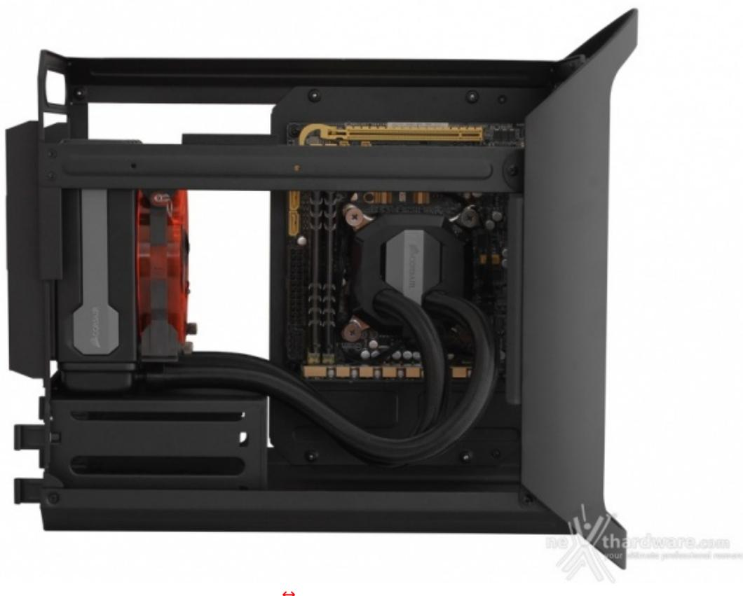
Anche l'AiO con radiatore da 120mm è facilmente montabile; nel nostro caso abbiamo deciso di sacrificare il supporto per drive da 2,5" e posizionare i tubi nella parte bassa del case in previsione
