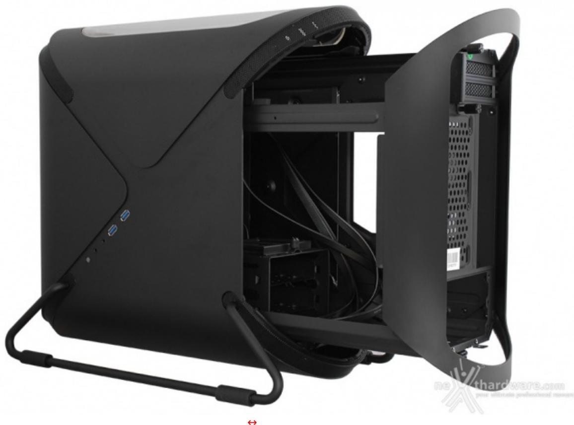
Per poter accedere all'interno del BitFenix Portal basterà rimuovere due viti zigrinate poste sul retro ed estrarre l'intera struttura interna utilizzando due apposite maniglie.
