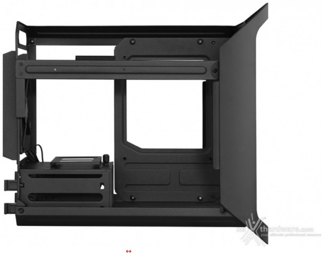
Il piatto mainboard, posizionato in alto a destra, può ospitare schede madri in formato mini-ITX ed è dotato di un ampio scasso per l'installazione di sistemi di raffreddamento per la CPU; non sono presenti fori ed
