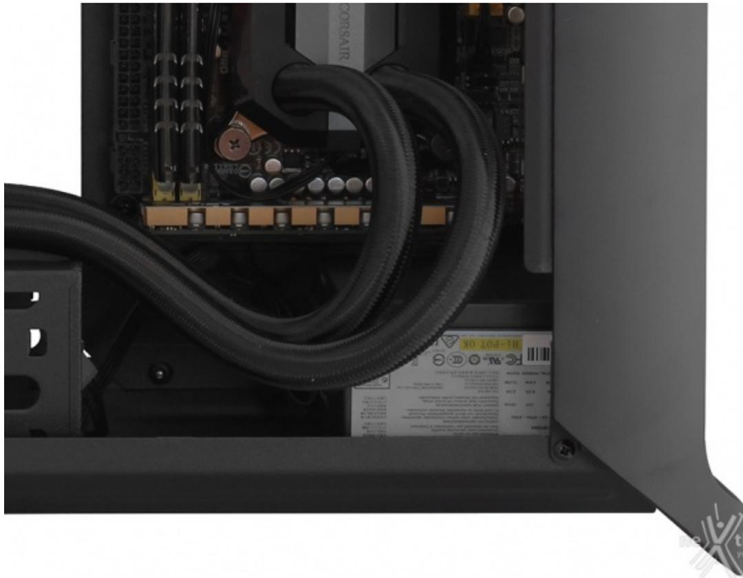
Abbiamo quindi installato l'alimentatore SFX sul fondo del case; dato l'esiguo spazio a disposizione consigliamo vivamente l'utilizzo di un'unità completamente modulare.
