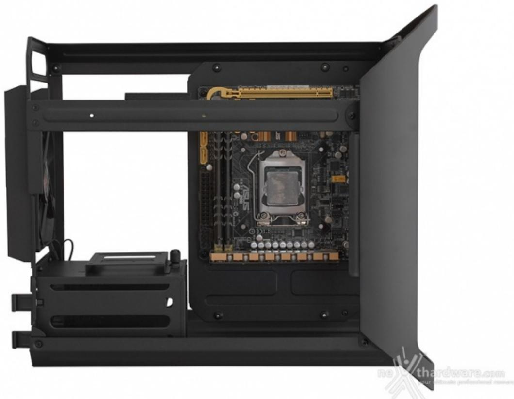
L'installazione della mainboard è abbastanza semplice, tutte e quattro le viti sono raggiungibili senza intoppi ma, per facilitare ancora di più la procedura, consigliamo di utilizzare un cacciavite abbastanza corto e calamitato.
