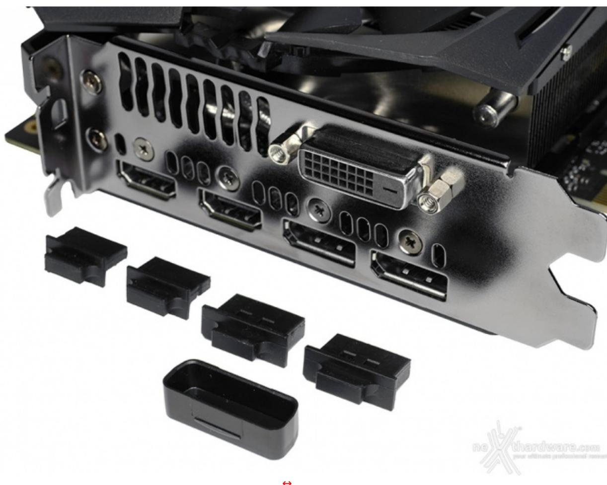
Per quanto riguarda gli ingombri, sebbene la staffa di fissaggio occupi solo due slot, ne sono necessari tre liberi per poter installare la scheda in quanto la cover del dissipatore, con relative ventole, occupa ulteriore spazio.
