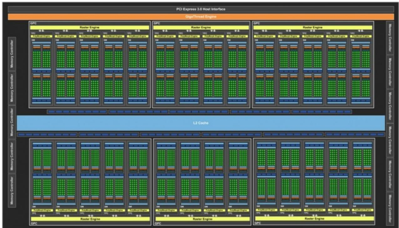
Come per Maxwell, gli SM di Pascal sono dotati di un buffer condiviso da 96kB, che permette di ridurre ulteriormente l'accesso alla cache L2 integrata o alla memoria esterna alla GPU, una cache L1 da 48kB e 256kB di spazio di archiviazione per i file di registro.
