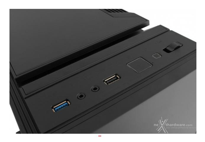
Nella zona frontale del top è presente il pannello di I/O composto (da sinistra verso destra) da una USB 3.0, due jack HD audio (cuffie e microfono), una USB 2.0, i pulsanti di accensione e reset ed un controller per ventole a tre velocità .
