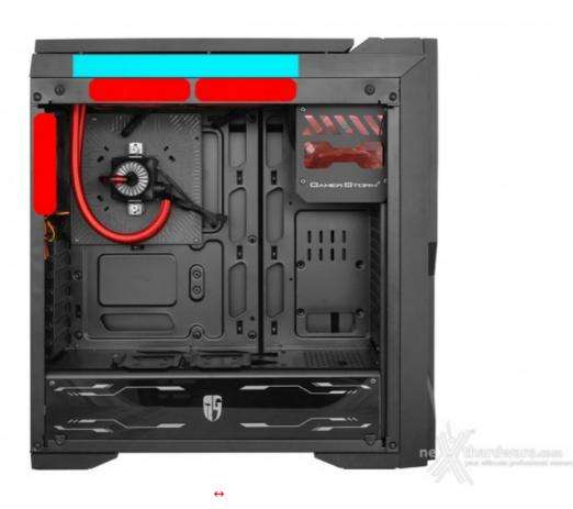
Il Dukase Liquid permette quindi l'utilizzo di radiatori da 120, 140, 240 e 280mm sul top, 120mm sul retro e 120 o 140mm lungo il frontale, tuttavia lo stesso viene già commercializzato con un Gamer Storm
