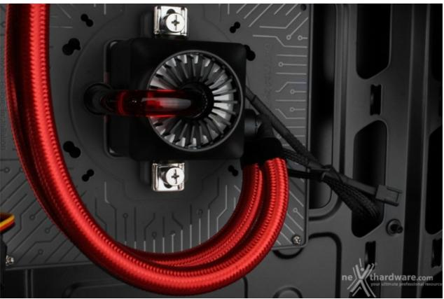
Il gruppo pompa/waterblock, fissato su di un supporto in plastica, è sicuramente tra i più particolari in commercio grazie al suo particolare look steam punk che permette di vedere, tramite un piccolo tubo in vetro trasparente, il liquido rosso contenuto all'interno del circuito.
