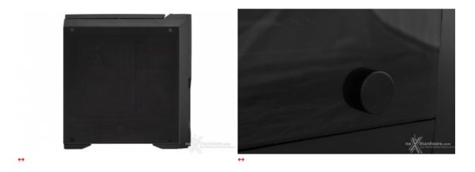
Al fine di rendere più accattivante il Dukase Liquid, la casa produttrice ha deciso di utilizzare un sistema di fissaggio simile a quello che ultimamente sta spopolando con i pannelli in vetro, ovvero delle "comode" viti zigrinate poste direttamente ai quattro angoli.
