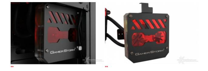
Quest'ultima ha un design estremamente aggressivo grazie all'uso di una cover metallica nera e offre la possibilità di osservare, attraverso il plexiglas, il liquido refrigerante e le due giranti in azione.
