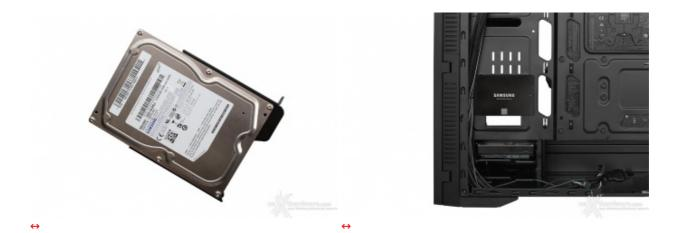
Sia i drive da 2,5" che quelli da 3,5" devono necessariamente essere fissati tramite viti; nel caso del Samsung 850 EVO montato sul retro del piatto mainboard non è presente una slitta ed il drive è stato avvitato direttamente al telaio.
