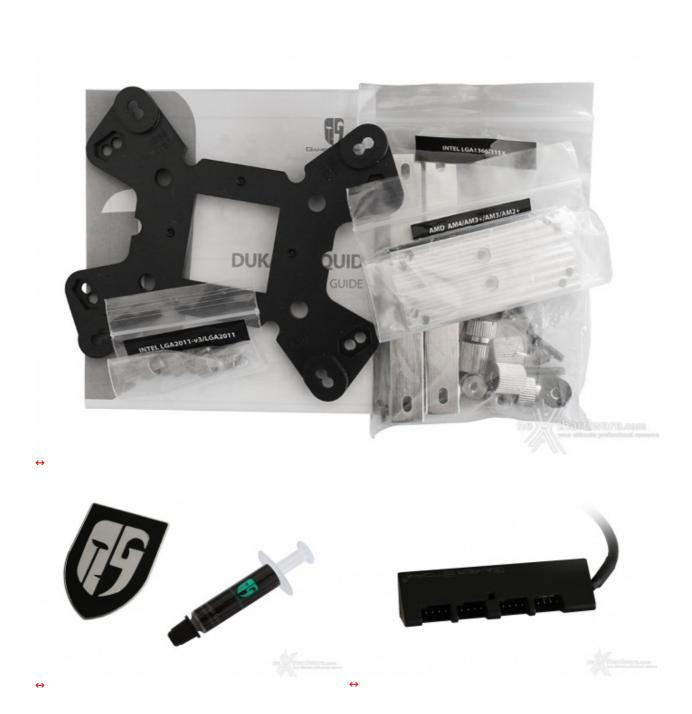
All'interno della prima sono presenti, oltre ad un semplice flyer per la garanzia, fascette e viti varie per l'installazione di mainboard e drive, mentre nella seconda troviamo, oltre ai sistemi di fissaggio del waterblock per i vari socket, un logo adesivo, un tubetto di pasta termica Gamer Storm ed un comodissimo HUB con quattro connettori PWM, ideale per effettuare un cablaggio pulito di pompa e ventole.
