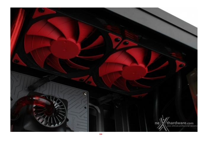
Il radiatore per due ventole da 120mm, grande 274x120x27mm, è utilizzabile anche in configurazione push/pull e, a differenza della versione base, presenta due tubi aggiuntivi che si uniscono alla particolare vaschetta.
