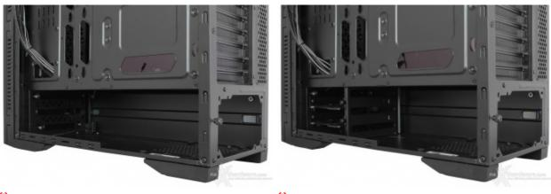
Togliendo la paratia destra, invece, possiamo accedere al vano alimentatore che vede, oltre alla già citata predisposizione per una ventola da 120mm sul frontale, un cestello removibile in grado di contenere due drive da 2,5" o 3,5" ed un terzo supporto da 2,5" posizionato in corrispondenza della rientranza sul piatto mainboard.
