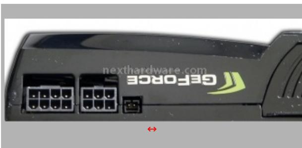
Per il corretto funzionamento della scheda, è necessario collegare due linee di alimentazione PCI-E, da 8 e 6 pin.
