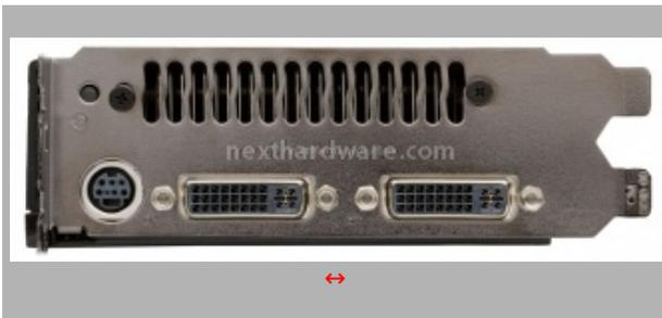
Sono disponibili due connettori DVI Dual LINK con supporto HDCP e HDMI per veicolare audio multicanale attraverso una connessione dati interna. Un piccolo led indica la corretta alimentazione della scheda, nel caso che, uno o entrambi i connettori di alimentazione non fossero correttamente collegati il led cambierà colore indicando il problema.
