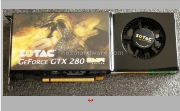
Come di consueto Zotac non ha personalizzato il design della scheda, ma si è attenuta alle specifiche delle reference NVIDIA. La frequenza operativa della GPU è stata analizzata di ben 100 Mhz e la scheda ha dimostrato ulteriore propensione a l'overclock.
