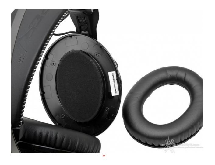
A protezione dell'elettronica è posta una copertura in plastica serrata agli angoli da quattro viti, sulla quale è incollato lo strato in microfibra, solitamente incorporato nel padiglione.
