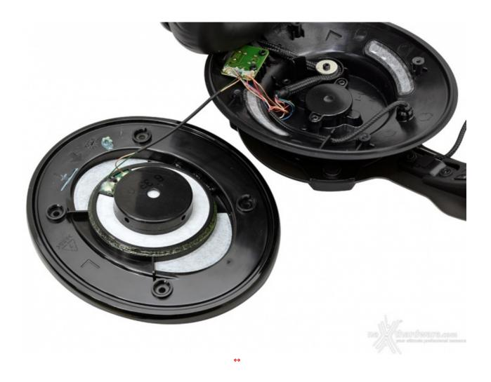
Una volta rimossa la plastica superiore sarà possibile accedere al cuore pulsante di queste HyperX Cloud Revolver S, un driver al neodimio da ben 50mm.
