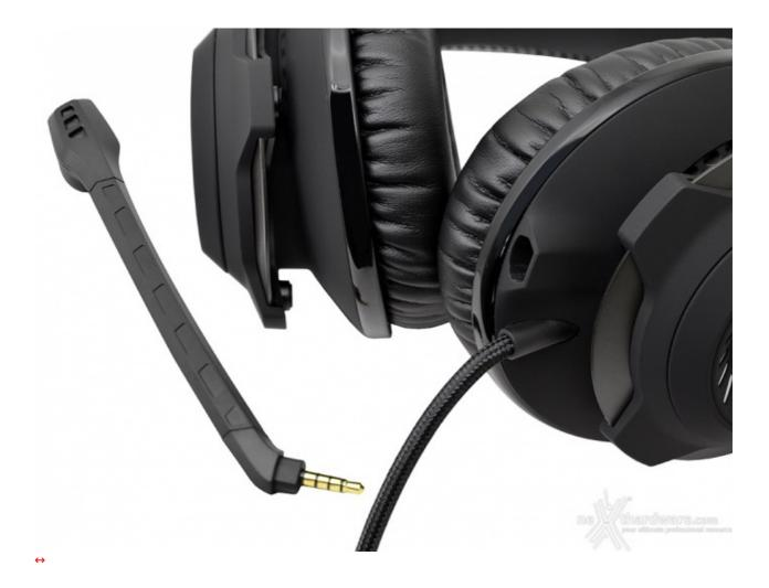
La zona inferiore delle cuffie accoglie il connettore jack per l'utilizzo del microfono ad asta flessibile incluso in dotazione.
