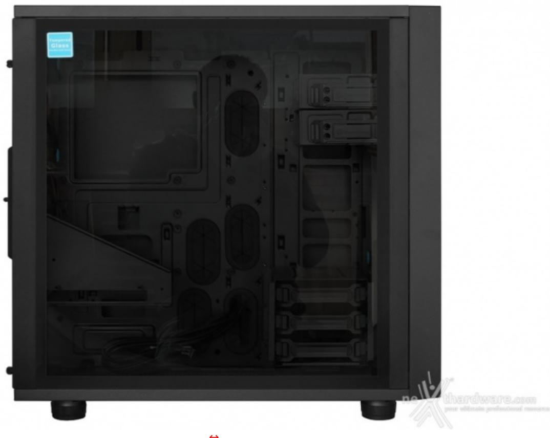
La paratia destra è realizzata completamente in acciaio e non vede caratteristiche degne di nota al contrario di quella a sinistra, vera protagonista di questa rivisitazione del Core X31, in quanto realizzata in vetro temperato da circa 4mm di spessore e dotata di telaio in plastica che la rende ancora più resistente.
