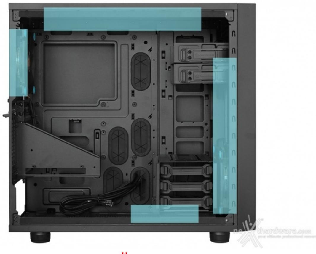
Per quanto concerne il raffreddamento a liquido è possibile installare un gran numero di radiatori, nello specifico uno da 120/140mm sul retro, uno da 120/140mm sul fondo, uno da 280/360mm sul top e uno da 280/360mm, molto spesso, sul frontale.
