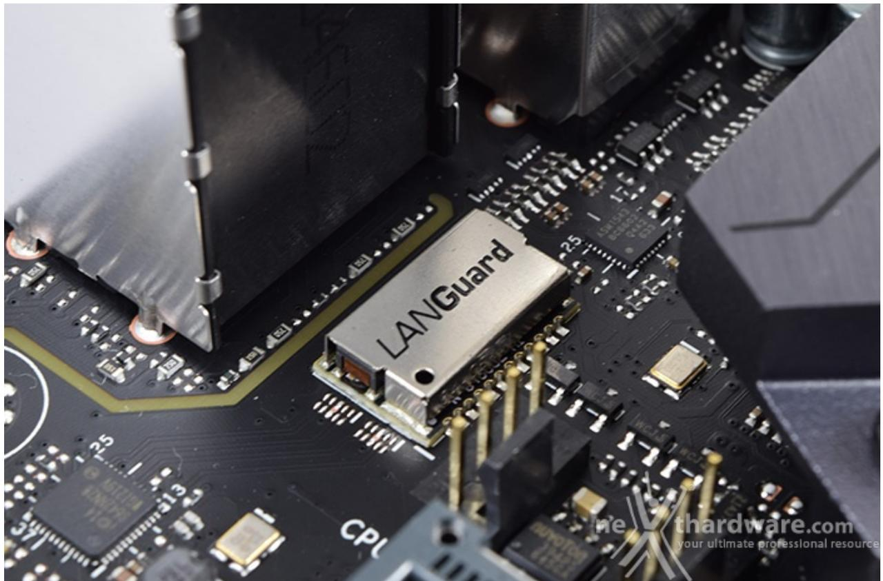
Infine, abbiamo la funzione LANGuard, ovvero un particolare connettore di rete progettato per offrire una protezione fino 1,9 volte superiore allo standard nei confronti degli effetti dell'elettricità statica e fino a 15kV contro fulmini e sovratensioni che possono propagarsi sulla rete.
