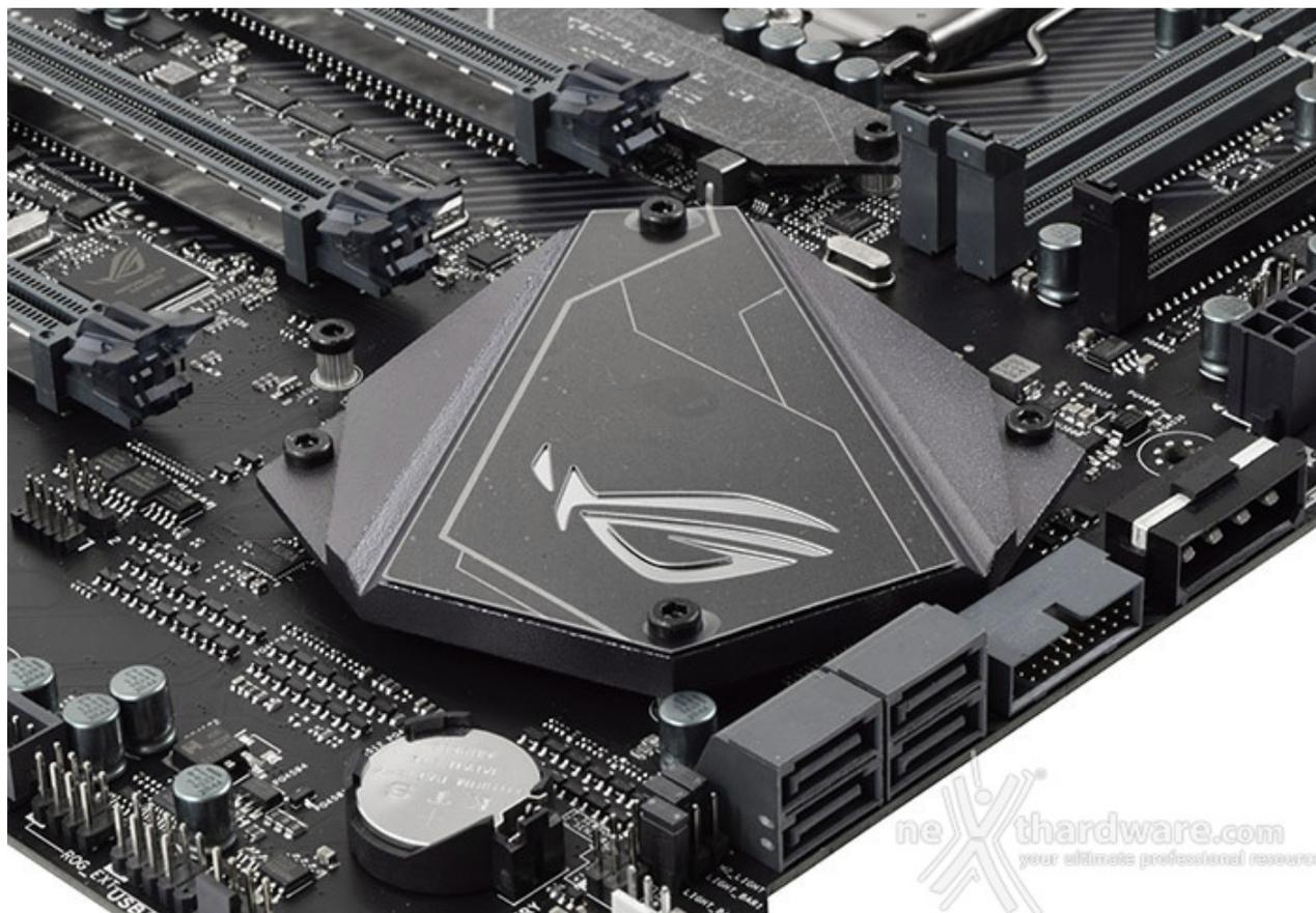
Sotto l'insero in stile ROG, provvisto del sistema di illuminazione AURA RGB, troviamo un secondo dissipatore, di dimensioni più contenute, preposto al raffreddamento del PCH Z270.
