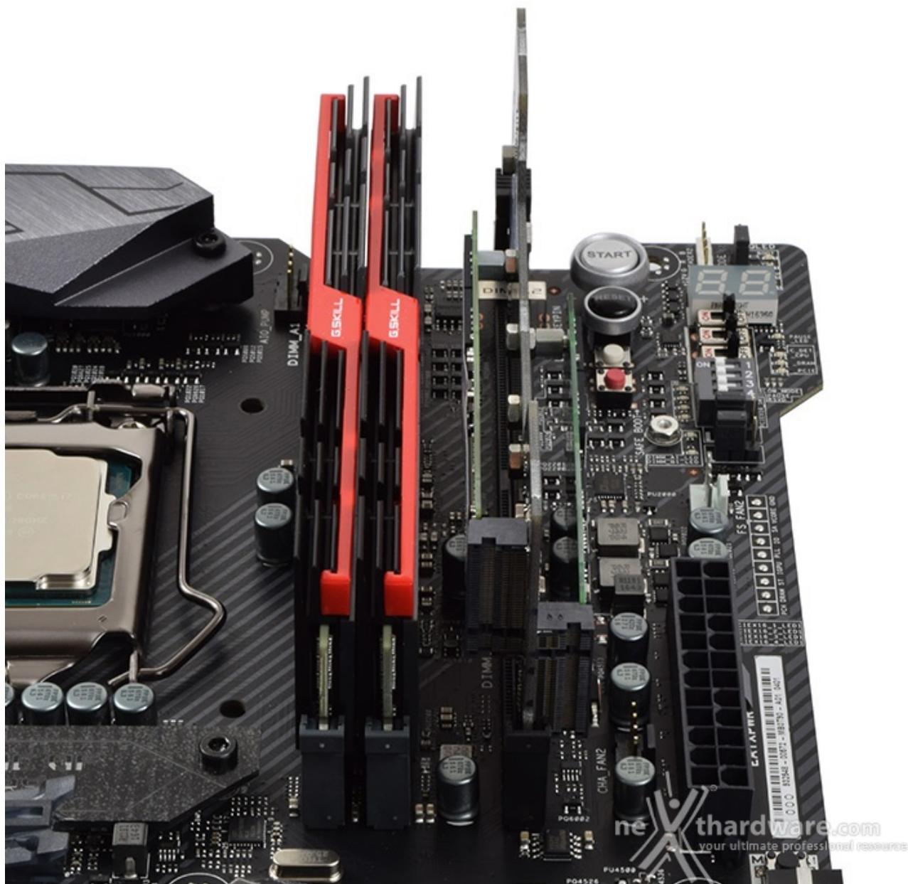
In caso si abbia la necessità di installare due SSD M.2 si avrà comunque uno spazio residuo↔ sufficiente per consentire una adeguata circolazione di aria per lo smaltimento del calore generato.
