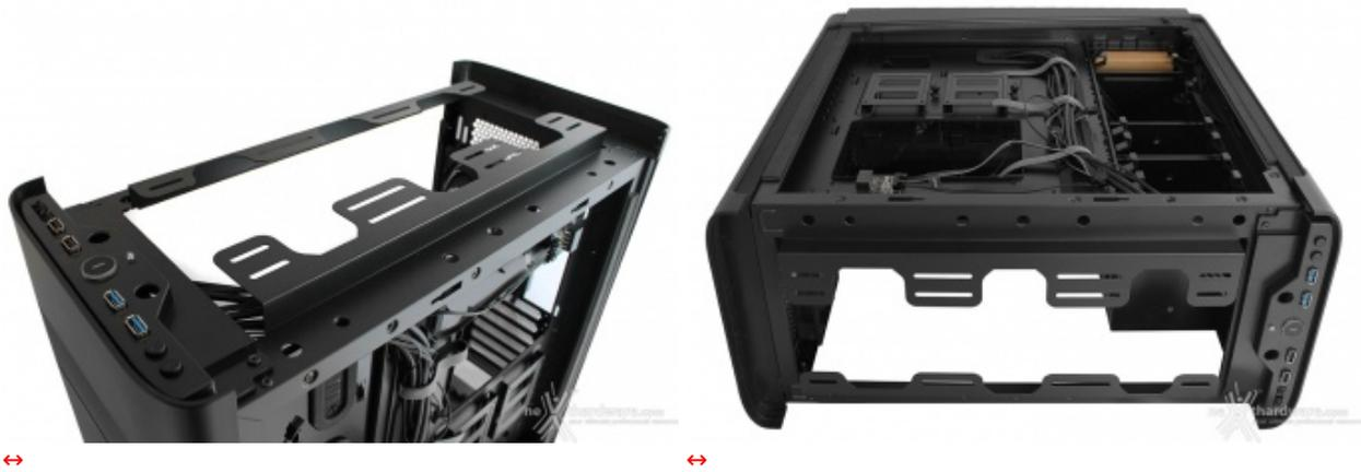
La restante parte superiore è coperta da un pannello in alluminio dalla forma simile a quello visto sul frontale e che può essere smontato solo previa rimozione di entrambe le paratie laterali, complicando quindi l'accessibilità alla predisposizione per ventole situata sotto di esso, ovvero tre unità da 120 o due da 140mm.
