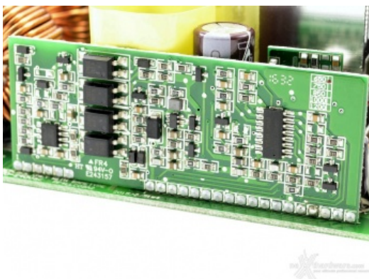
Particolare del chip preposto ai sistemi di protezione.
