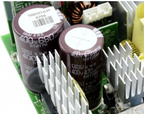
Condensatori Nippon Chemi-Con KMR.
