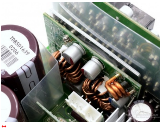
Particolare del Modulo DC-DC.
