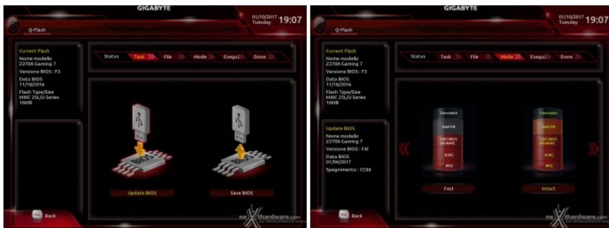
La sezione **"Q-Flash"**, accessibile da tutte le pagine tramite l'apposito Tab a scomparsa, permette di effettuare l'update del BIOS tramite un Flash Drive USB, ma anche di effettuare il backup del BIOS sul chip secondario, in maniera tale da avere anche il secondo chip costantemente aggiornato all'ultima release.
