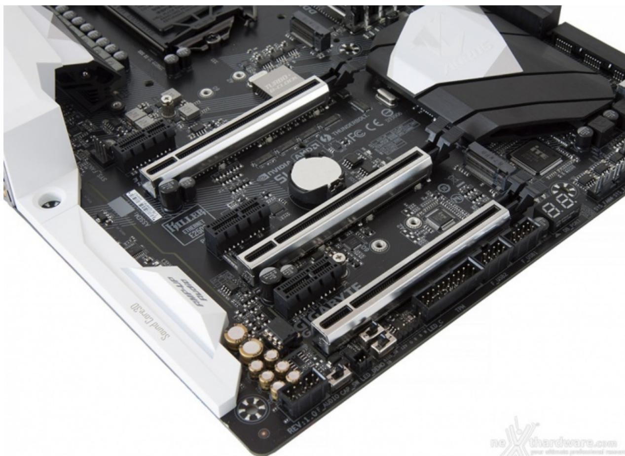
Nelle foto in alto possiamo osservare tutta la dotazione di slot PCI-E comprendente tre PCIe 3.0 x1 ed altri tre PCIe 3.0 x16 funzionanti, rispettivamente, in modalità x16, x8 e x4.
