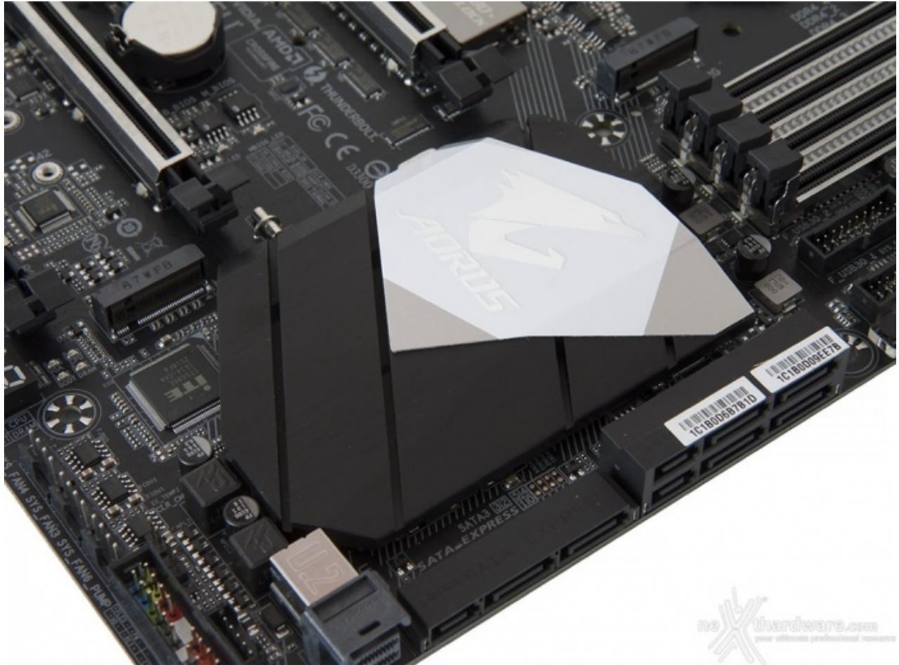
Un terzo dissipatore, di altezza leggermente ridotta, è quello preposto al raffreddamento del PCH Z270.
