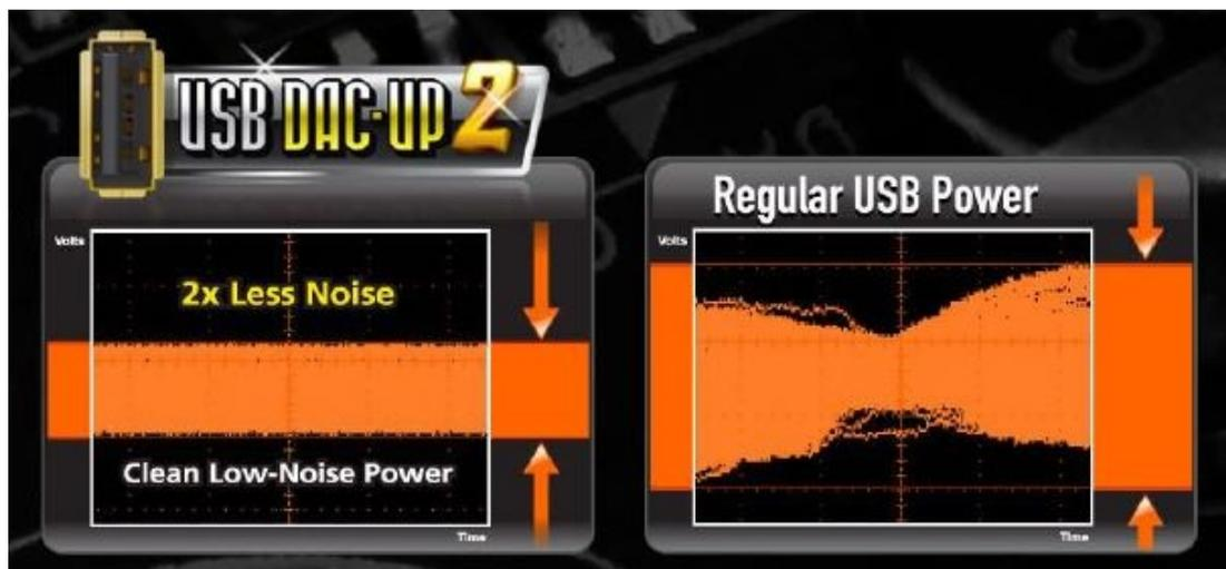
Queste porte sono dotate di un circuito di potenza dedicato in grado di erogare una tensione costante nel tempo e priva di qualsiasi forma di rumore, risultando così ideali per il collegamento di periferiche audio USB di elevata qualità .
