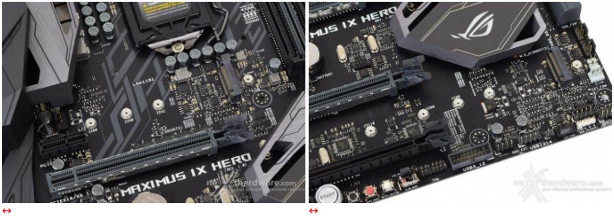
Il primo di essi, denominato M.2\_1 e posizionato tra il socket ed il primo slot PCI-E, è compatibile unicamente con SSD M.2 di lunghezza pari a 42, 60 e 80mm e supporta connessioni di tipo PCI-E 3.0 x4 (sino a 32 Gb/s) nonché SATA III.
