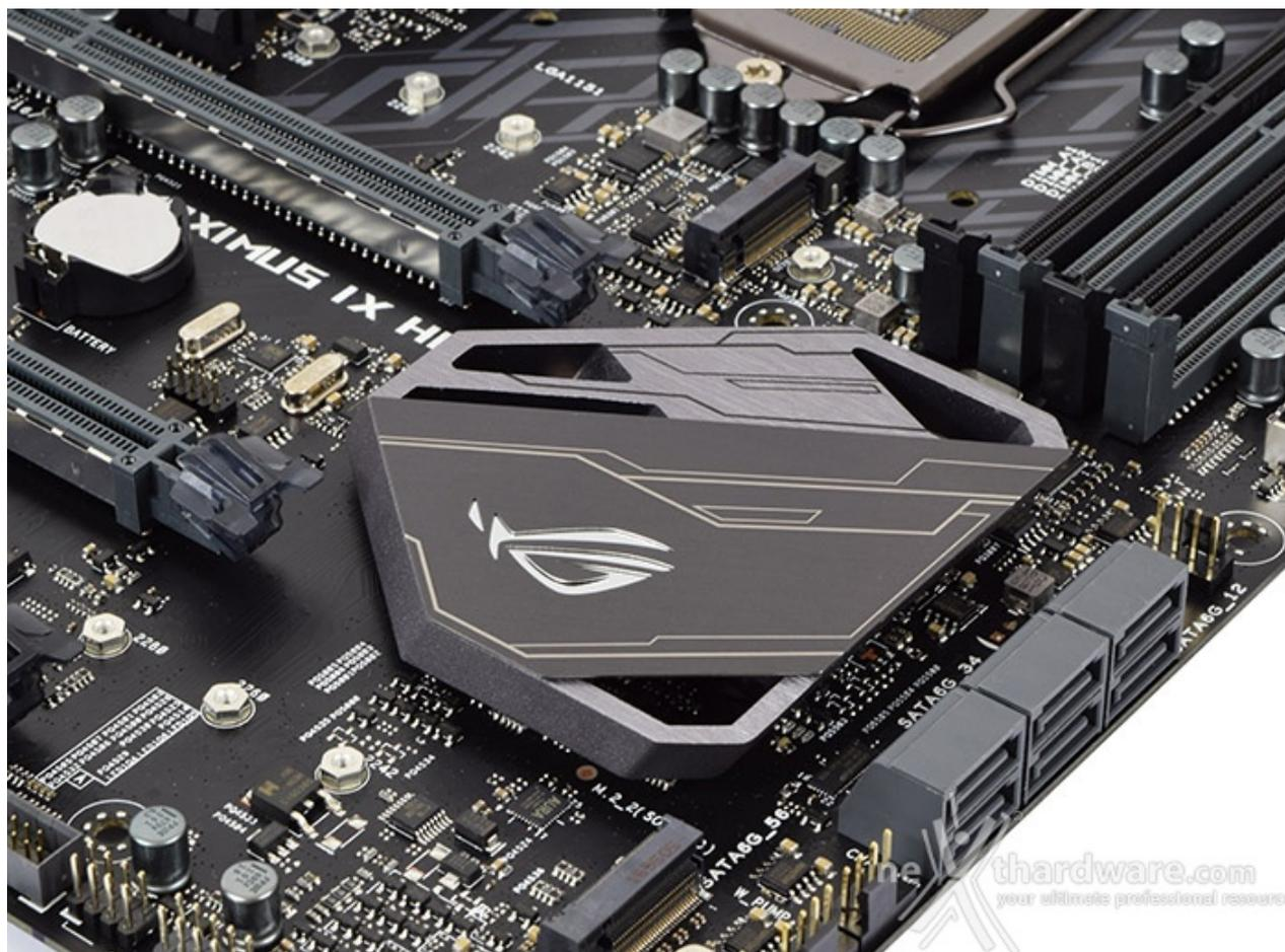
Sotto l'inserito in stile ROG, provvisto del sistema di illuminazione AURA RGB, troviamo un secondo dissipatore di dimensioni più contenute, ma anch'esso ampiamente alleggerito, preposto al raffreddamento del PCH Z270.
