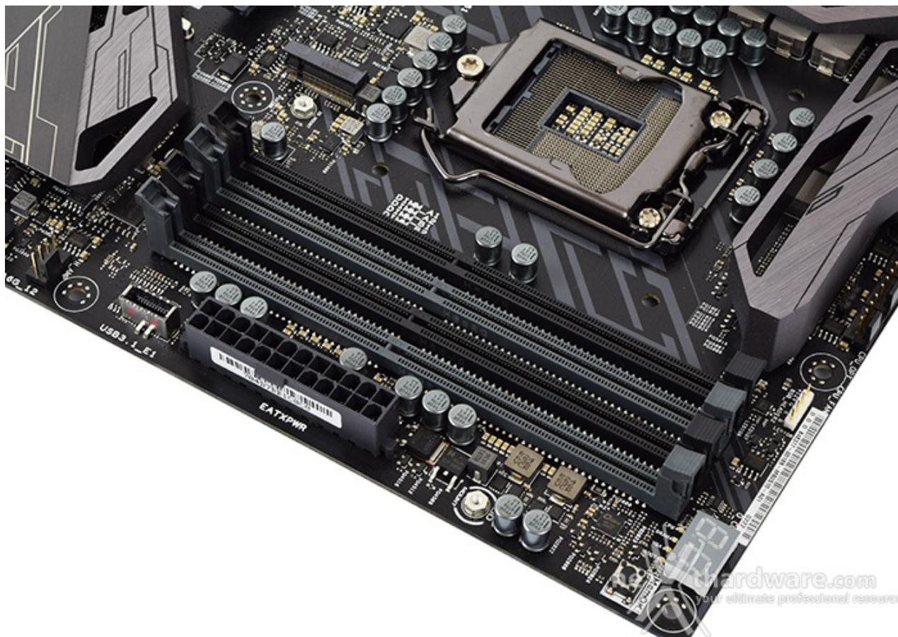
Da notare, infine, il particolare design degli stessi che prevede il meccanismo di ritenzione solo sul lato esterno per consentire di smontare i moduli anche in presenza di una VGA installata sul primo slot PCIe.
