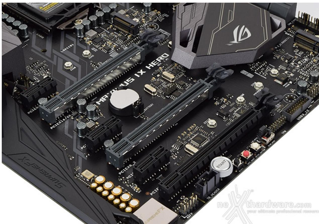
Nella foto in alto possiamo osservare la dotazione di slot PCI-E, tutti con connessione di tipo 3.0, comprendente tre x1 ed altri tre con velocità pari a, rispettivamente, x16, x8 e x4.
