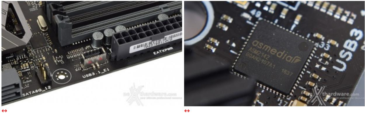
I tradizionali controller USB 3.1 utilizzano prevalentemente una connessione PCI-E Gen3 x1 oppure una PCI-E Gen2 x2, limitando di fatto questa tipologia di porte ad velocità massima di pari, rispettivamente, a 8 Gb/s e 10 Gb/s.
