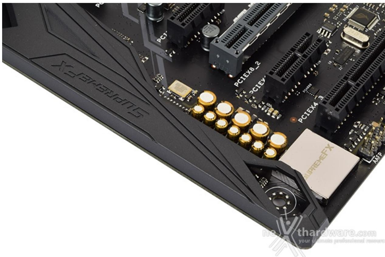
La sezione audio, come del resto per tutta la serie MAXIMUS IX, è di altissimo livello: siamo infatti di fronte ad una soluzione **SupremeFX S1220** CODEC, realizzata in collaborazione con Realtek, capace di garantire un rapporto segnale/rumore di 120dB in uscita e 113dB in ingresso, in accoppiata ad un **DAC ESS Sabre ES9023P** che supporta la modalità High Definition 7.1 canali e lo streaming multiplo dal pannello frontale e da quello posteriore.
