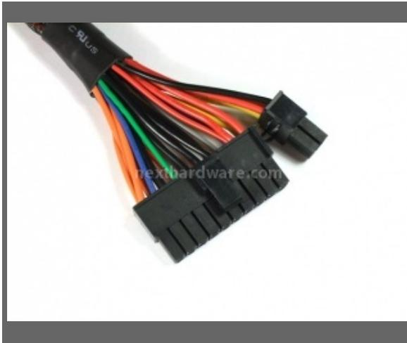
Cavo di alimentazione ATX 20/24pin
