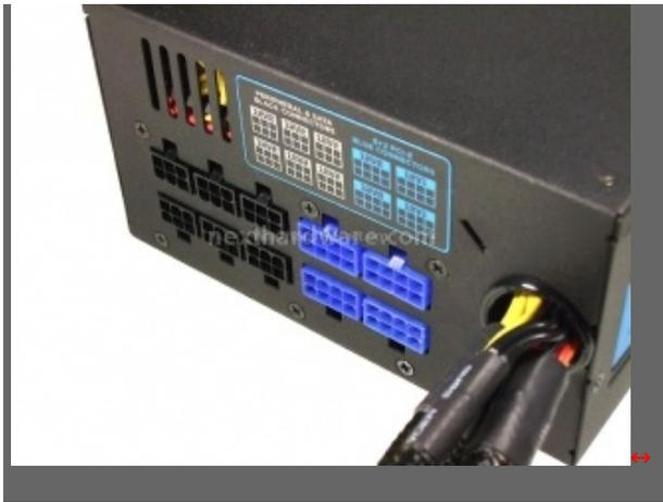
Lato connessioni modulari. Impossibile sbagliare una connessione il grafico e' estremamente chiaro. Dobbiamo segnalare che, come per altri alimentatori, terminare lo sleeving dei cavi fuori dal box non è di bellissimo impatto estetico.
