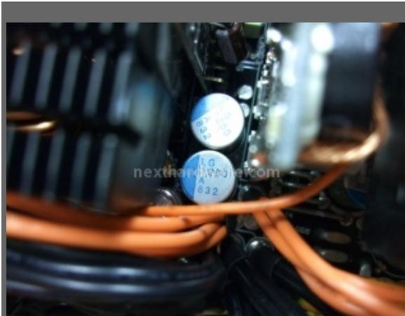
Ogni singola linea in uscita è accostata ad almeno una coppia di questi Solid-Capacitor. Prodotti utilizzati prettamente nelle sezioni di alimentazione delle mainboard hi-end per computer.
