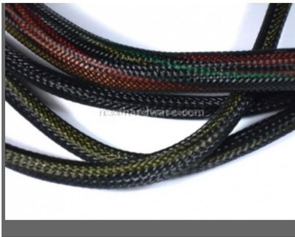
Tutti i cavi saldati di questo alimentatore utilizzano lo stesso tipo di rivestimento con maglia multifilo. Ad eccezione di un cavo modulare, anch'esso rivestito, il resto dei cablaggi presenta una disposizione a piattina.
