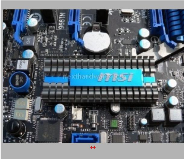
Il cuore della MSI P55-GD80 è sotto questo piccolo dissipatore in alluminio: Chipset Intel P55
