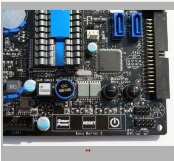
Il bottone per l'attivazione di OC Genie è protetto da una ghiera di plastica che ne impedisce inserimento accidentale. Una volta attivo, il bottone si illumina per indicarne il suo stato.
