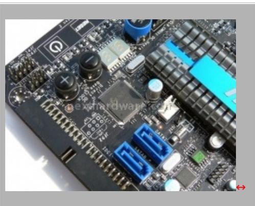
La MSI P55-GD80 è dotata di 6 porte SATA II gestite dal controller del P55, porte di colore nero ruotate di 90° per non interferire con le schede video. Le restanti 2 porte SATA II, 1 porta E-SATA Combo USB (Back I/O), 1 porta EIDE ATA133 sono gestite da un controller JMicron JMB363 (visibile nella seconda foto). Il P55 supporta le modalità RAID 0/1/5/10 e ACHI attraverso l'Intel Matrix Storage, il controller JMicron supporta invece le sole modalità 0/1 e JBOD
