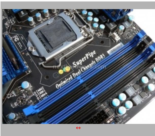
Il chipset P55 è progettato per supportare fino a 16 GB di memoria RAM DDR3, per limitazioni dello stesso, la memoria massima allocabile è in realtà di poco superiore ai 15 GB. A differenza della piattaforma X58, i canali di memoria disponibili sono due invece che tre, limitando a 128 bit l'interfaccia tra la CPU e le RAM. In caso fossero popolati solo due slot di memoria, i moduli devono essere inseriti negli slot 1 e 3 (slot neri) pena il mancato avvio del sistema.
