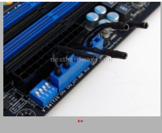
I V-Check Points sono posizionati in prossimità del connettore ATX, posizione non comoda ingombra dal cavo di alimentazione, le prolunghe V-Check Cable rendono però il lavoro più semplice spostando il punto di misura in una posizione più consona. A fianco dei V-Check Points è presente uno switch per abilitare le funzionalità di overvolt dal BIOS della P55-GD80.
