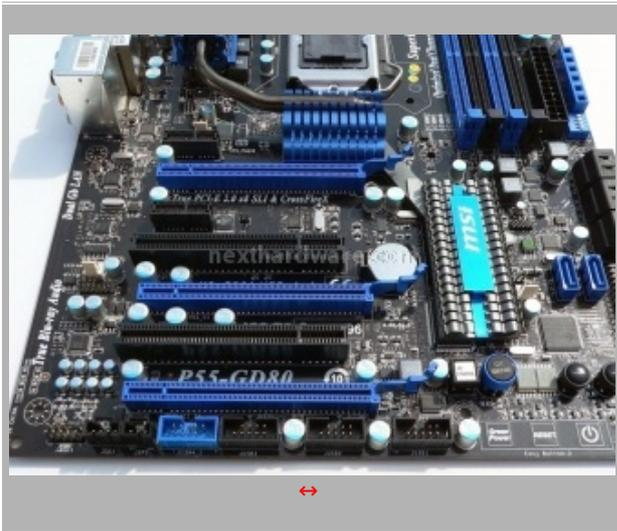
I processori Core i3, i5, i7 per socket 1156 integrano al loro interno un controller PCI-E 16x collegato direttamente alle schede video di sistema. La MSI P55-GD80 permette l'installazione di un massimo di 3 schede video operanti rispettivamente in modalità 8x " 8x " 4x. La terza scheda video non è gestita direttamente dal controller della CPU ma da quello contenuto nel chipset P55. Nel caso fosse presente una sola VGA nel primo slot, questa lavorerà a piena velocità .
