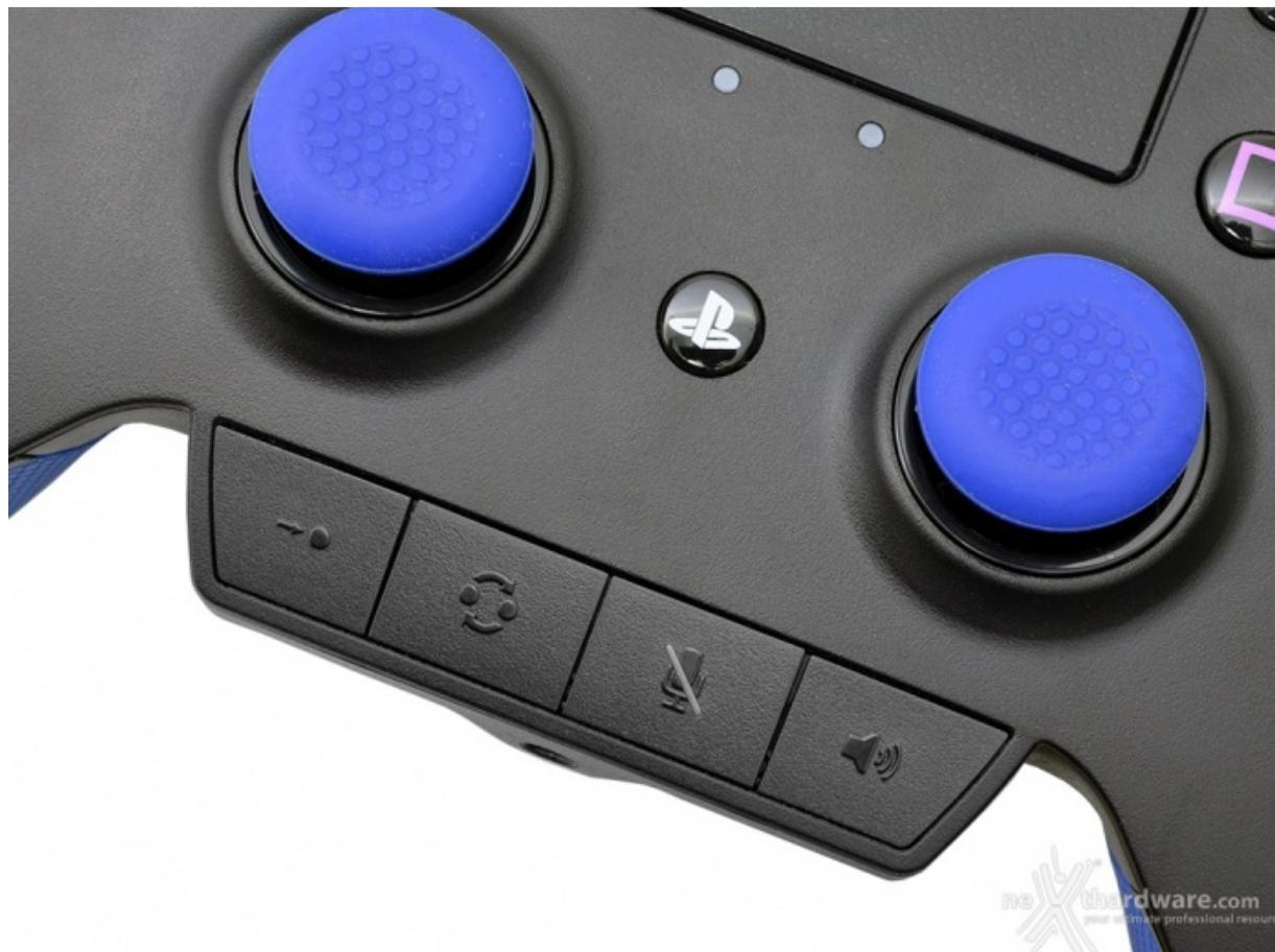
Il pannello di controllo integrato nel Razer Raiju dispone di quattro pulsanti di cui due dedicati alla gestione dei profili hardware personalizzabili (Default, 1 e 2) e due che si occuperanno della gestione del microfono e del volume una volta collegato un headset al connettore jack da 3.5mm di cui è dotato e visibile in basso.
