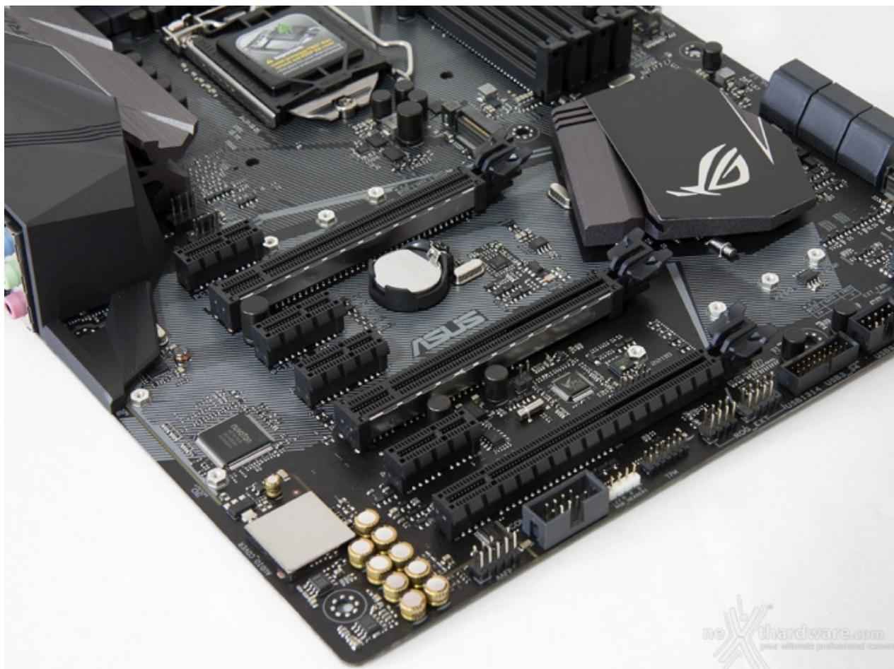
Nelle foto in alto possiamo osservare tutta la dotazione di slot PCI Express comprendente quattro PCIe 3.0 x1 ed altri tre PCIe 3.0 x16 funzionanti rispettivamente in modalità x16, x8 e x4.
