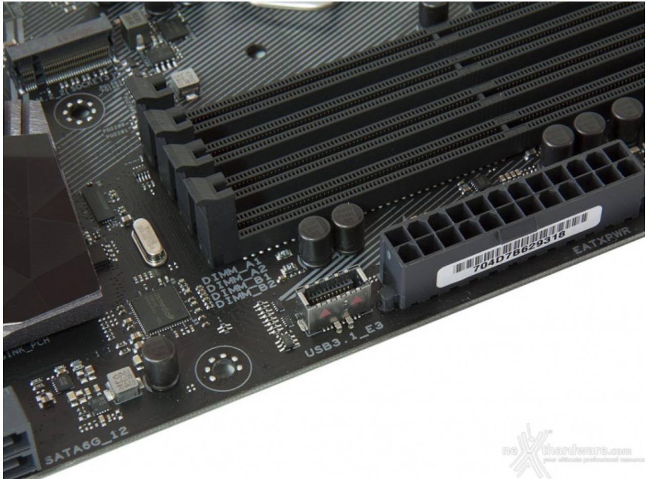
Una delle novità introdotte con le nuove mainboard Z270 è la presenza di un header USB 3.1 che, nel caso della ROG STRIX Z270E GAMING, va ad affiancare gli USB 3.0 ed USB 2.0 atti a garantire la retrocompatibilità con le vecchie periferiche.
