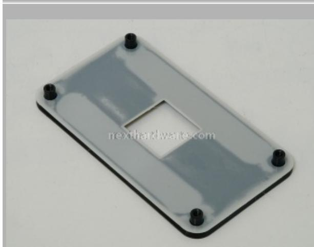
Il montaggio su socket AMD, oltre al backplate, necessita di un ulteriore cestello. Quest'ultimo (nella foto in basso)
