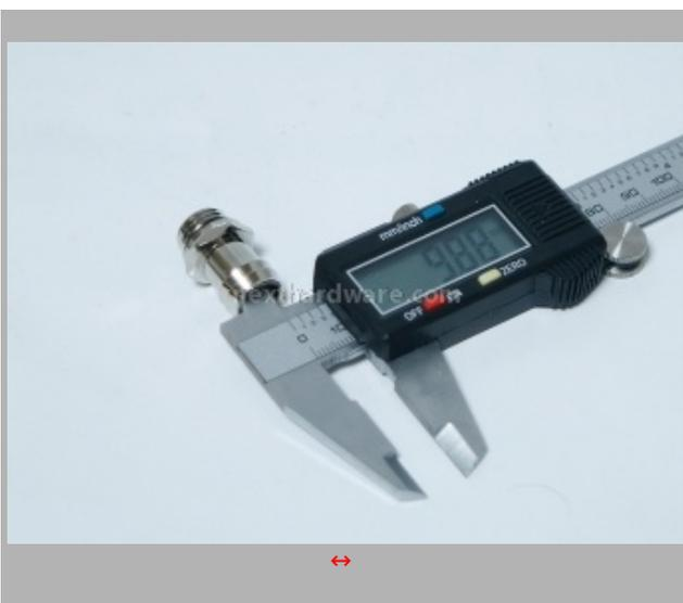
I raccordi in dotazione presentano sulla base uno scavo per accogliere l'o-ring di tenuta. Generoso come di consueto il diametro interno che risulta di poco inferiore ai 10mm.
