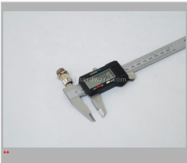
I nuovi raccordi (a dx) differiscono leggermente dai precedenti; è stato introdotto uno svaso per l'o-ring sulla base così da tenerlo in sede durante il serraggio.
