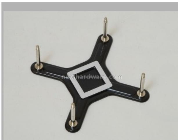
In dotazione vi è un backplate per socket 775. Quest'ultimo integra le viti passanti che verranno sfruttate per il serraggio del waterblock.
