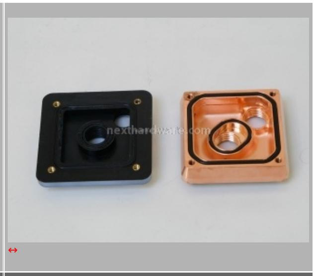
Si notano subito le differenze sul diffusore; i fori di raccolta del flusso sul perimetro sono stati maggiorati per ridurre al minimo la caduta di pressione. Inoltre l'altezza della camera soprastante la base è stata ridotta da 4,5 a 4mm circa. Questo permette di incrementare la velocità del flusso a contatto con la base; in seguito apprezzeremo i frutti di questa scelta.
