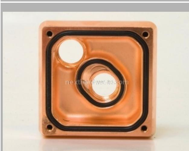
Particolare della parte inferiore del top. La guarnizione al centro consente di garantire che il flusso in ingresso sia direzionato totalmente verso il centro della base mentre l'o-ring più esterno garantisce la tenuta ermetica del waterblock.
