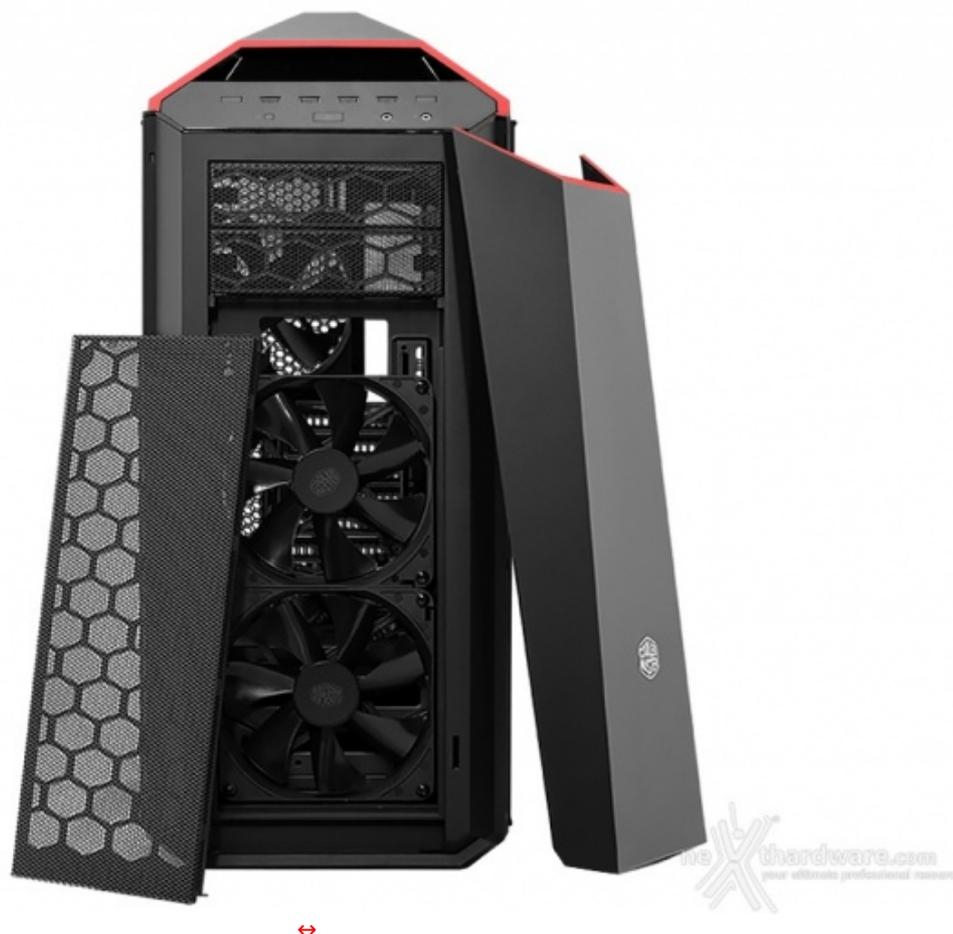
La griglia anteriore può essere facilmente sganciata per operare sulle due ventole da 140mm fornite di serie su questo case, così come le due cover a protezione dei vani da 5,25" che, una volta rimosse, non solo permetteranno di agire sui due cestelli interni, ma anche, all'occorrenza, di montare una terza ventola da 140mm usufruendo dell'adattatore presente in dotazione.
