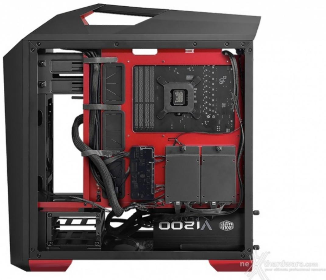
Nello step successivo abbiamo posizionato tutti i cavi necessari per il funzionamento del sistema, aiutandoci con le canaline passacavo e le varie fascette in velcro fornite in bundle su questo case.
