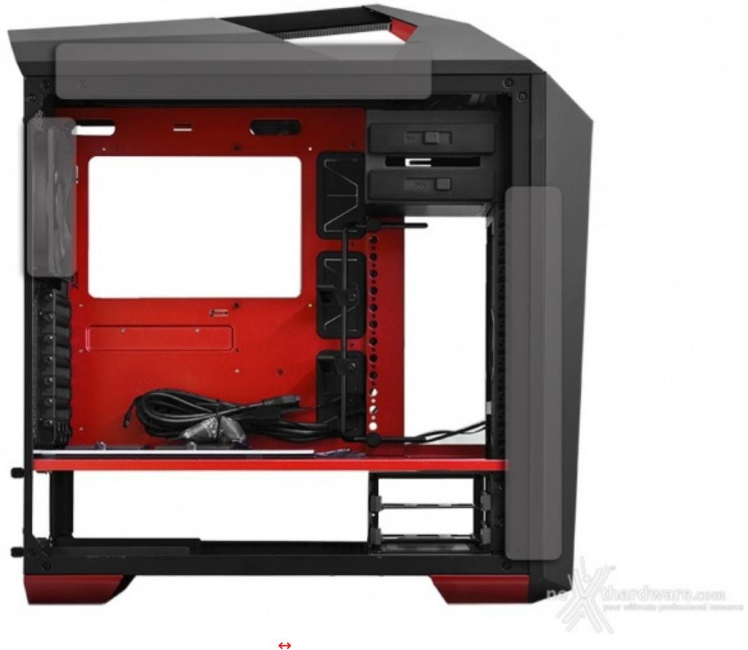
Per quanto concerne l'installazione di un sistema di raffreddamento a liquido, il MasterCase Maker 5t è in grado di supportare radiatori da 280mm spessi 40mm (ventole incluse) sul frontale, da 120/140mm nella zona posteriore e da 280mm sul top, tuttavia, in quest'ultimo caso, è bene effettuare la propria scelta basandosi sugli ingombri della scheda madre che si intende montare.
