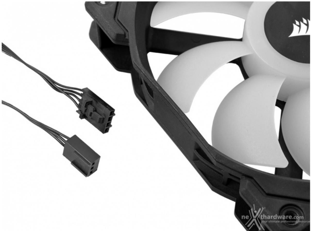
Come è possibile notare dalle foto in alto, le SP120 RGB sono dotate di ben due connettori, uno 3 pin per l'alimentazione del rotore ed uno proprietario 4 pin dedicato all'alimentazione e alla gestione delle modalità di illuminazione dei LED RGB tramite controller.
