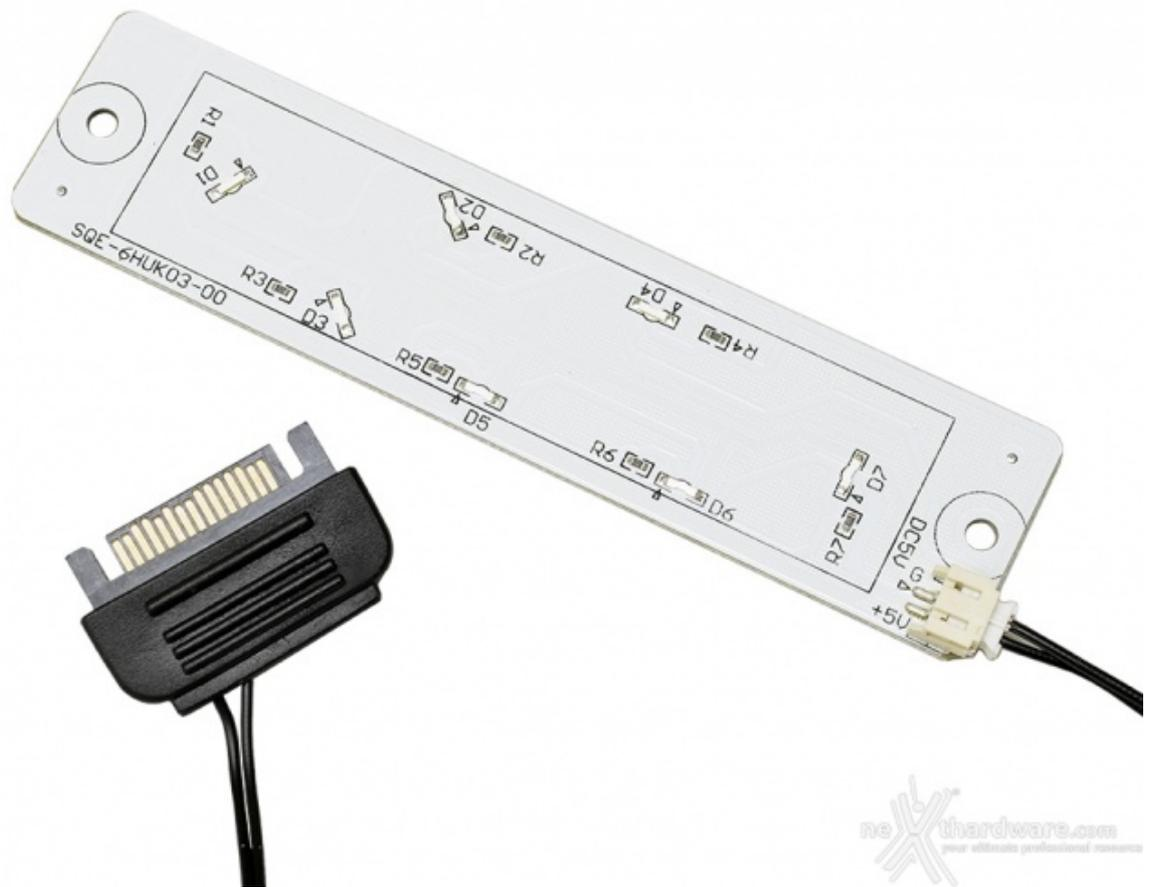
Il sistema di illuminazione del logo posto in corrispondenza della cover dell'alimentatore prevede l'utilizzo di sette diodi LED a luce bianca calda, alimentati da un connettore SATA Power.
