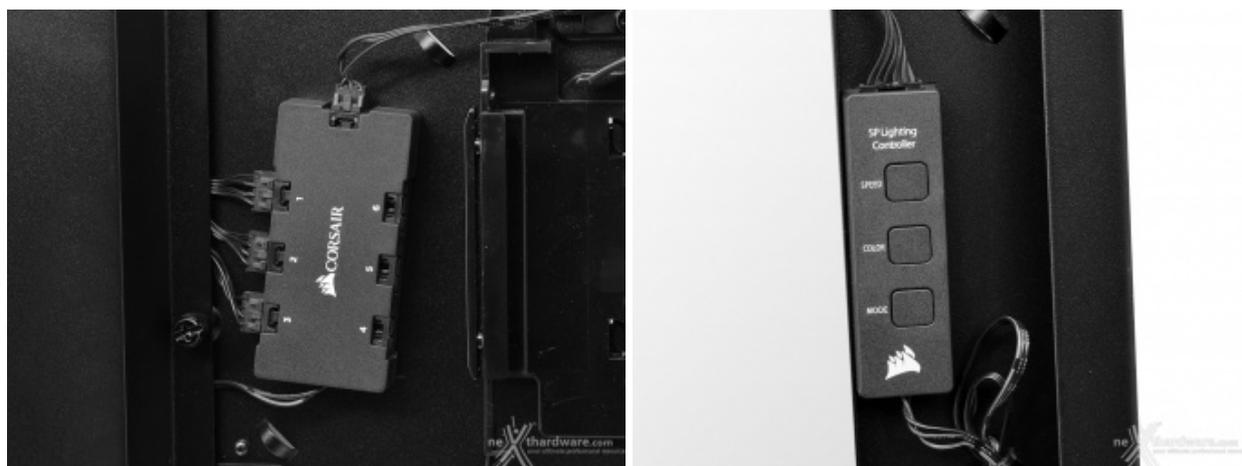
Giungiamo quindi al controller delle nuove ventole Corsair (SP120 RGB e HD120 RGB) fornito di serie con il modello in prova e posizionato in punti strategici del case.
