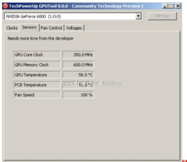
La sezione fan control invece permette di crearsi una curva personalizzata della rotazione delle ventole in funzione delle temperature.
