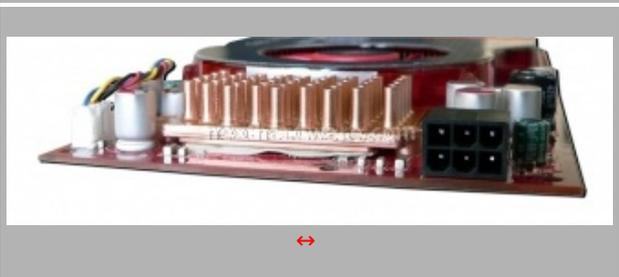
La sezione di alimentazione è ben dimensionata e completamente raffreddata da un dissipatore in rame a pin. Come tutte le schede di fascia medio/alta, è necessario collegare un cavo di alimentazione PCI-E 6 pin.
