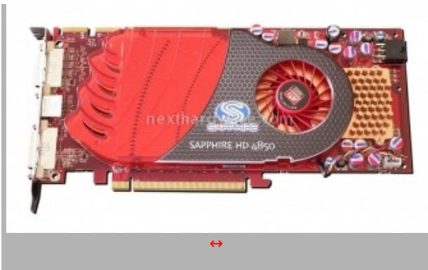
La HD 4850 proposta da Sapphire segue fedelmente il design proposto da ATI. Il dissipatore single slot è interamente in rame e copre, come vedremo in seguito, anche la sezione di alimentazione. La maggior parte dei condensatori utilizzati sono allo stato solido, segno di una buona cura nei dettagli costruttivi.
