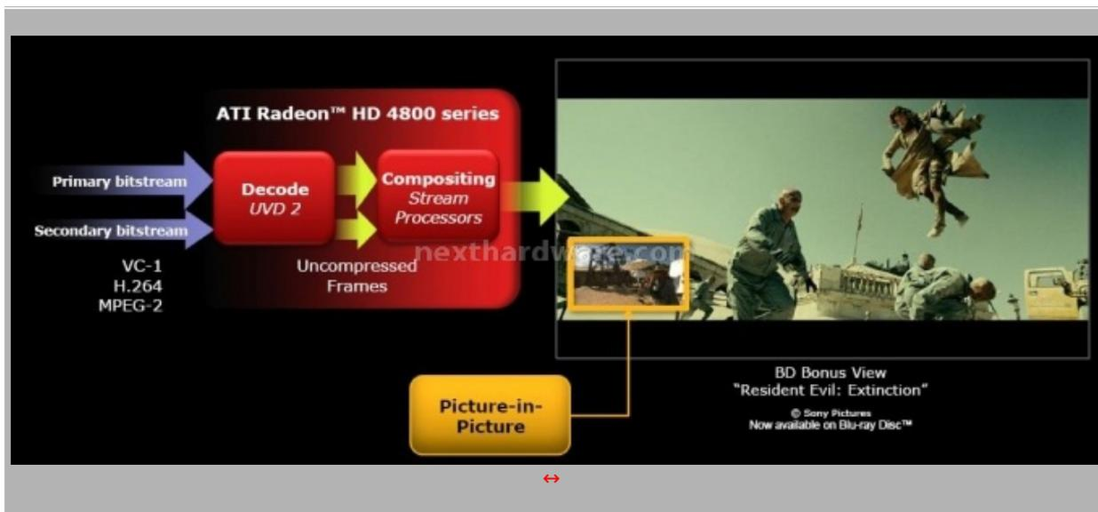
I due flussi video vengono codificati contemporaneamente e assemblati in un'unica immagine. L'UVD2 supporta i codec HD VC-1 e H.264 e il codec utilizzato dai normali DVD MPEG-2.
