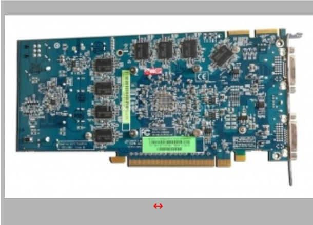
Sul retro sono presenti 8 dei 16 moduli GDDR4 prodotti da Samsung. Purtroppo non è presente alcun sistema di raffreddamento per questi componenti, anche se in condizioni normali di funzionamento non abbiamo però rilevato temperature eccessive o instabilità .
