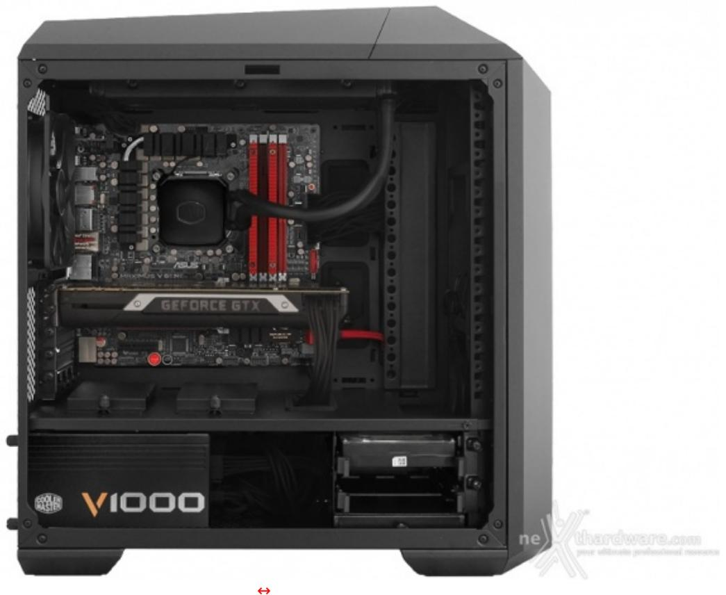
La presenza del supporto mobile per cestelli ha permesso anche di posizionare i cavi in modo "alternativo": si noti come il 24pin non passi dall'asola laterale.
