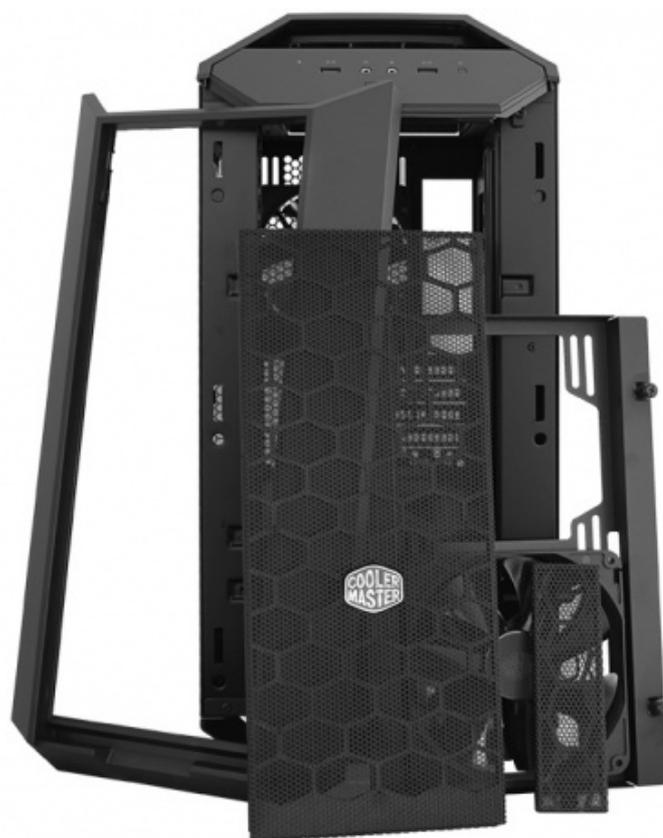
Tale supporto, fermato al telaio tramite quattro viti a testa zigrinata, può essere quindi estratto per assemblare a parte il gruppo ventole radiatore che diventerà, quindi, un blocco unico da dover semplicemente riavvitare al telaio.
