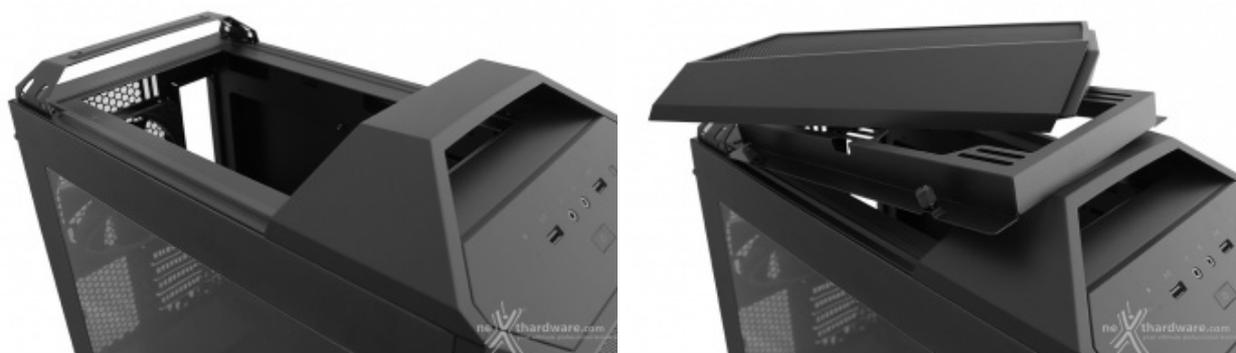
Anch'esso fissato al telaio tramite quattro viti, permette l'installazione di due ventole da 120 o 140mm, ma non di radiatori da 240/280mm che, per problemi di spazio, dovranno essere necessariamente montati al di sotto delle stesse.
