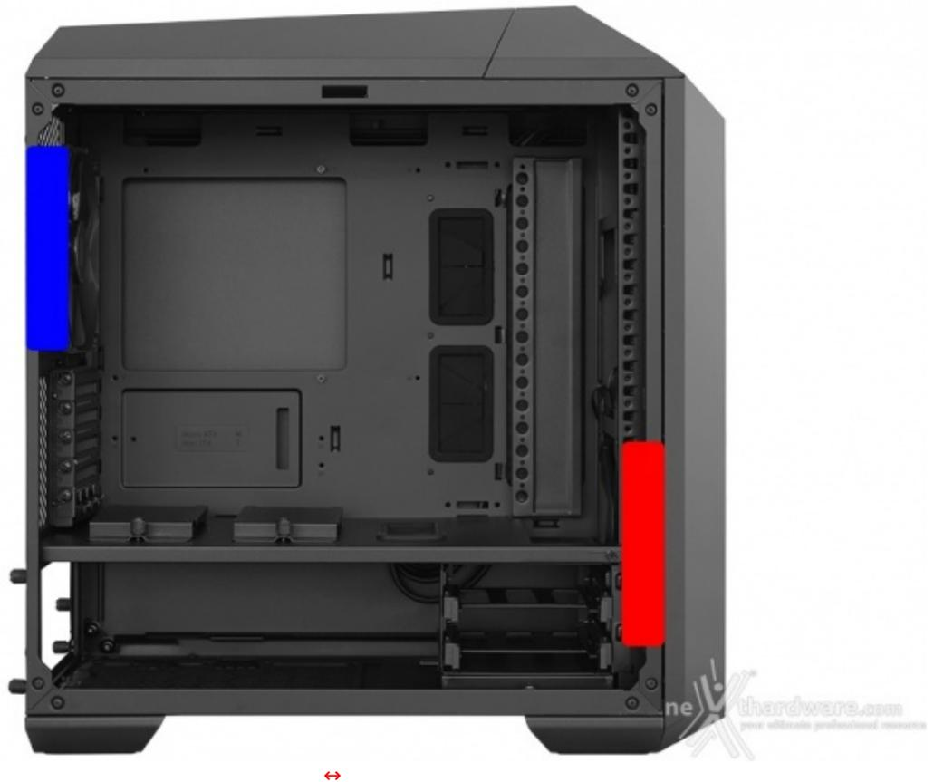
Il case è commercializzato con due ventole da 140mm, di cui una posizionata frontalmente in immissione ed una posteriormente in estrazione.
