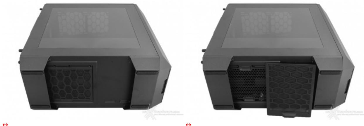
Da tale prospettiva è possibile osservare come l'intera struttura poggi su due generose staffe in acciaio, con tanto di gommini antivibrazione, sagomate ad hoc per mantenere inalterato il design complessivo.
