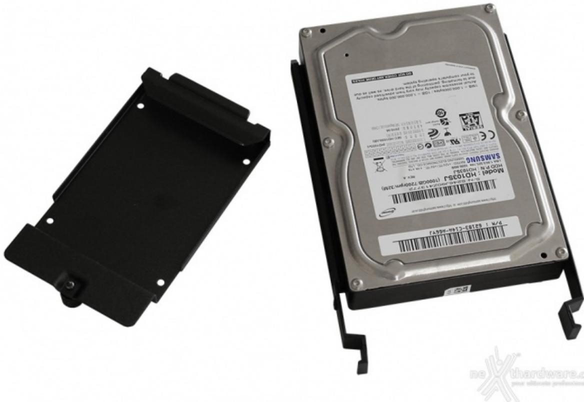
Il disco meccanico da 3,5" è stato bloccato sull'apposita slitta senza l'ausilio di strumenti, così come i due SSD da 2,5" che, per l'occasione, sono stati montati all'interno del supporto dedicato.
