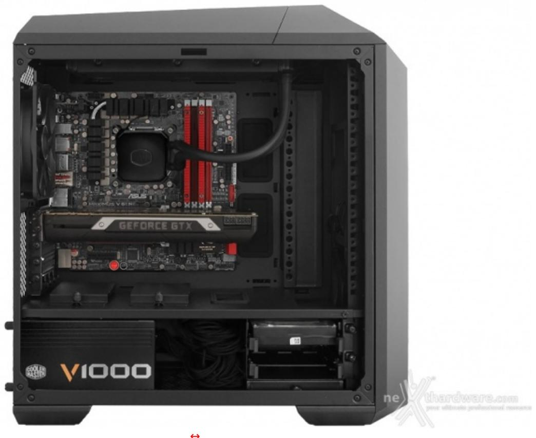
Una volta fissato al relativo bezel, l'alimentatore è stato inserito facilmente nel vano a lui dedicato con ampio margine sulla parte frontale per la disposizione dei cavi.
