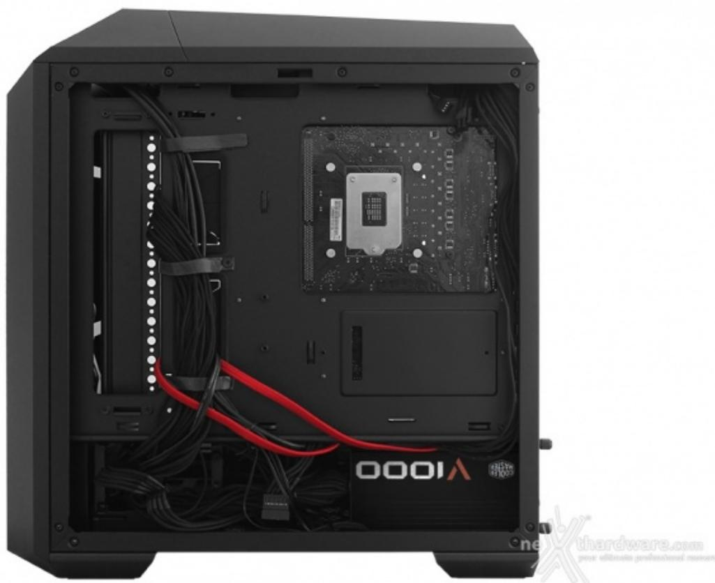
Date le dimensioni compatte del case abbiamo deciso di effettuare il cablaggio senza prolunghe per l'alimentazione della scheda video e della scheda madre, anche se la distanza tra la struttura interna ed il pannello di destra, di ben 17mm, consente, in caso di necessità, l'utilizzo di una gran mole di cavi.
