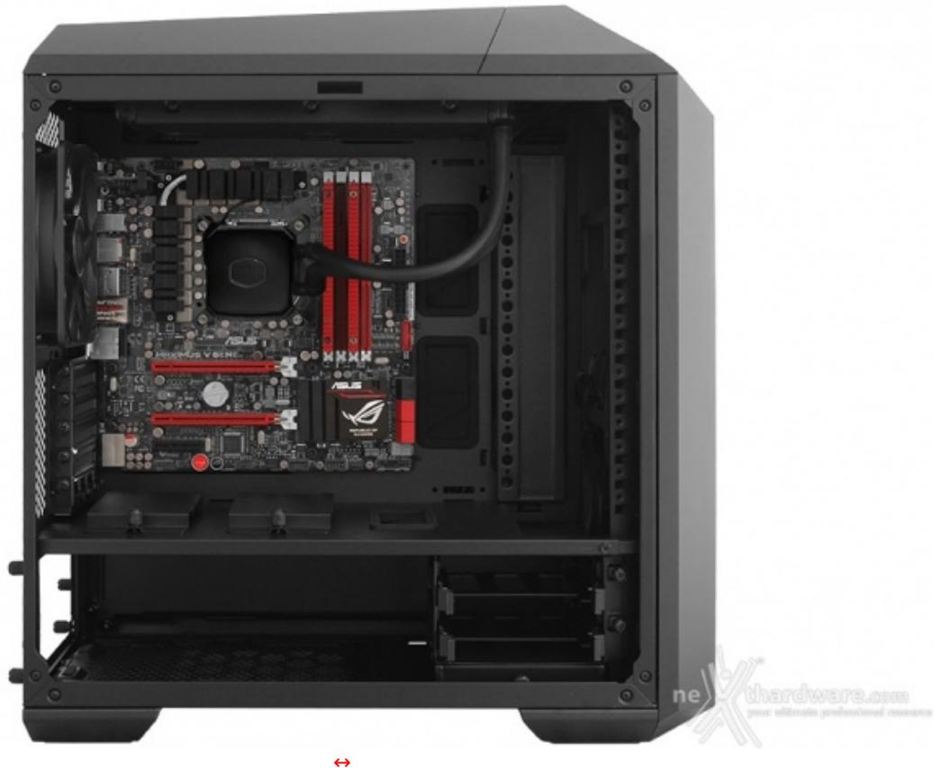
Il montaggio del nostro AiO è risultato altrettanto immediato: la possibilità di smontare i supporti per ventole per poi rimontarli a radiatore installato torna molto utile soprattutto quando si ha a che fare con modelli da 240mm.
