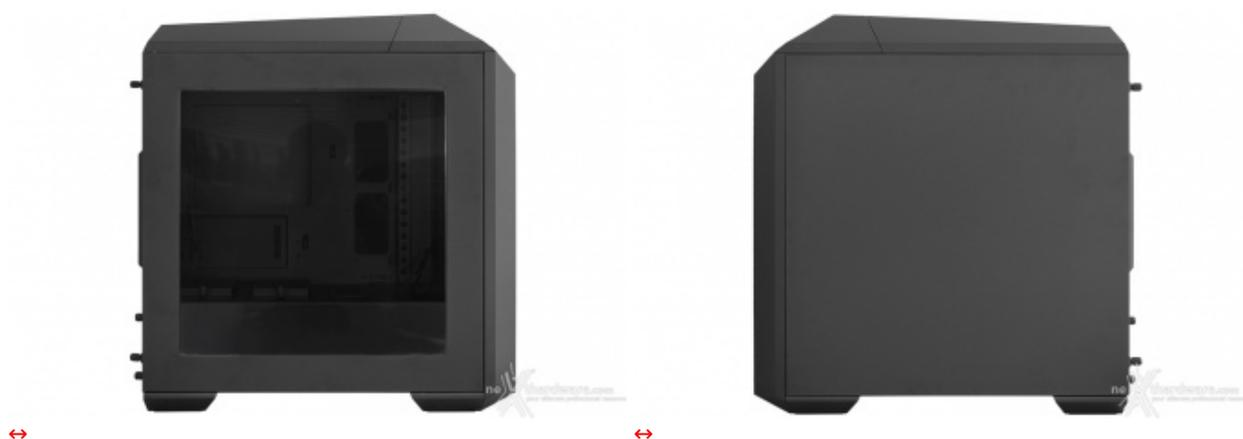
I pannelli laterali sono entrambi solidi e di ottima qualità con quello di sinistra che, nonostante l'ampia finestra in plexiglass, risulta poco incline a flettersi anche sotto sforzo.
