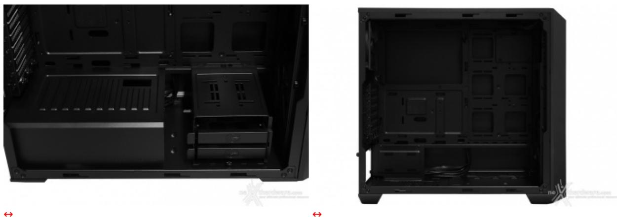
Il vano alimentatore presenta un coperchio in plastica removibile che, ovviamente, tornerà particolarmente utile per coprire i cavi in eccesso.
