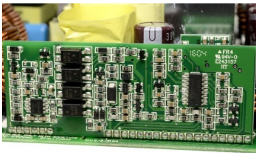
Particolare del chip preposto ai sistemi di protezione.
