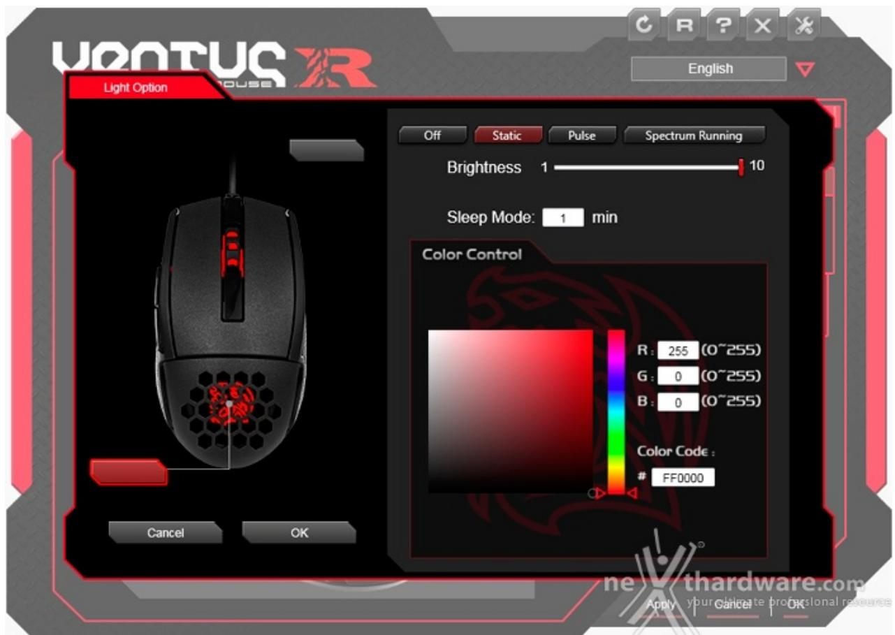
Le opzioni di illuminazione si basano sulla presenza di due differenti zone dotate di LED RGB da programmare con l'ausilio di una tavolozza o in maniera più precisa grazie ai valori RGB o ai codici esadecimali.
