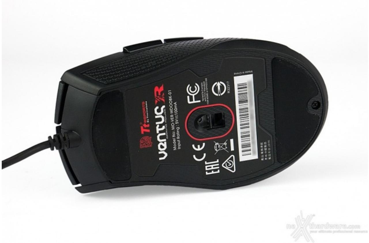
Per la base Tt eSPORTS ha optato per una configurazione a due pad surfer in teflon nero di dimensioni generose, in mezzo ai quali troviamo la feritoia del sensore ottico PixArt PMW 3310 da 5000 DPI.
