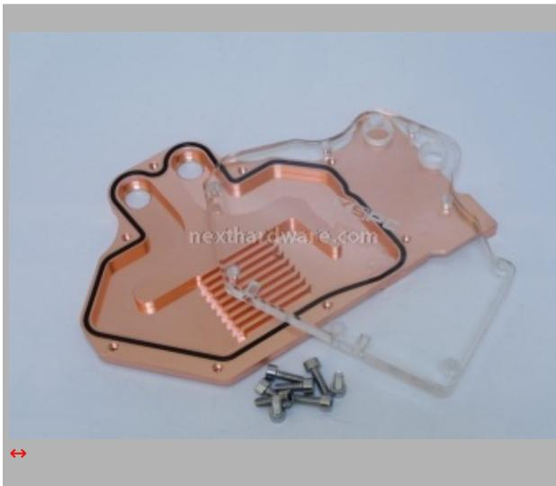
Il waterblock smontato. Com'era facile intuire anche da una prima occhiata il waterblock è composto da una base in rame e un top in plexy accoppiate tramite otto viti con testa cilindrica ad esagono incassato. La tenuta idraulica è garantita da un o-ring che trova alloggio nella base.
