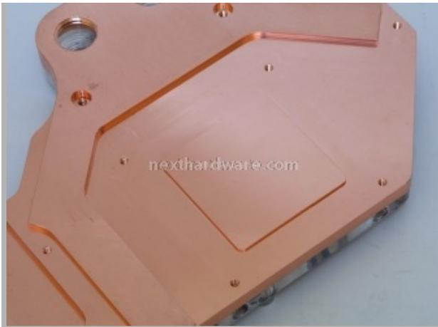
La zona a contatto della base è in rilievo; la finitura è di ottima qualità sebbene non sia perfettamente a specchio. A lato possiamo notare le varie filettature per il fissaggio del wb alla scheda video.
