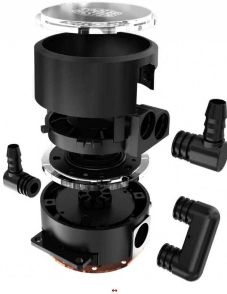
Una delle principali innovazioni di questo prodotto è per l'appunto il waterblock, caratterizzato da una tecnologia definita "Dual Chamber" che prevede l'installazione di pompa e piastra di rame in due zone distinte tra loro.
