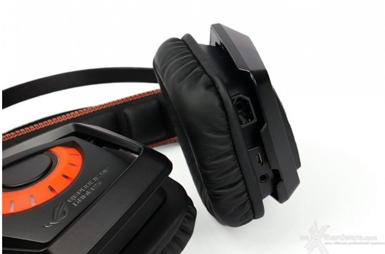
Oltre alla connessione per il microfono removibile, il padiglione sinistro ospita una porta Micro-USB per la ricarica e l'ingresso del jack per la modalità cablata.
