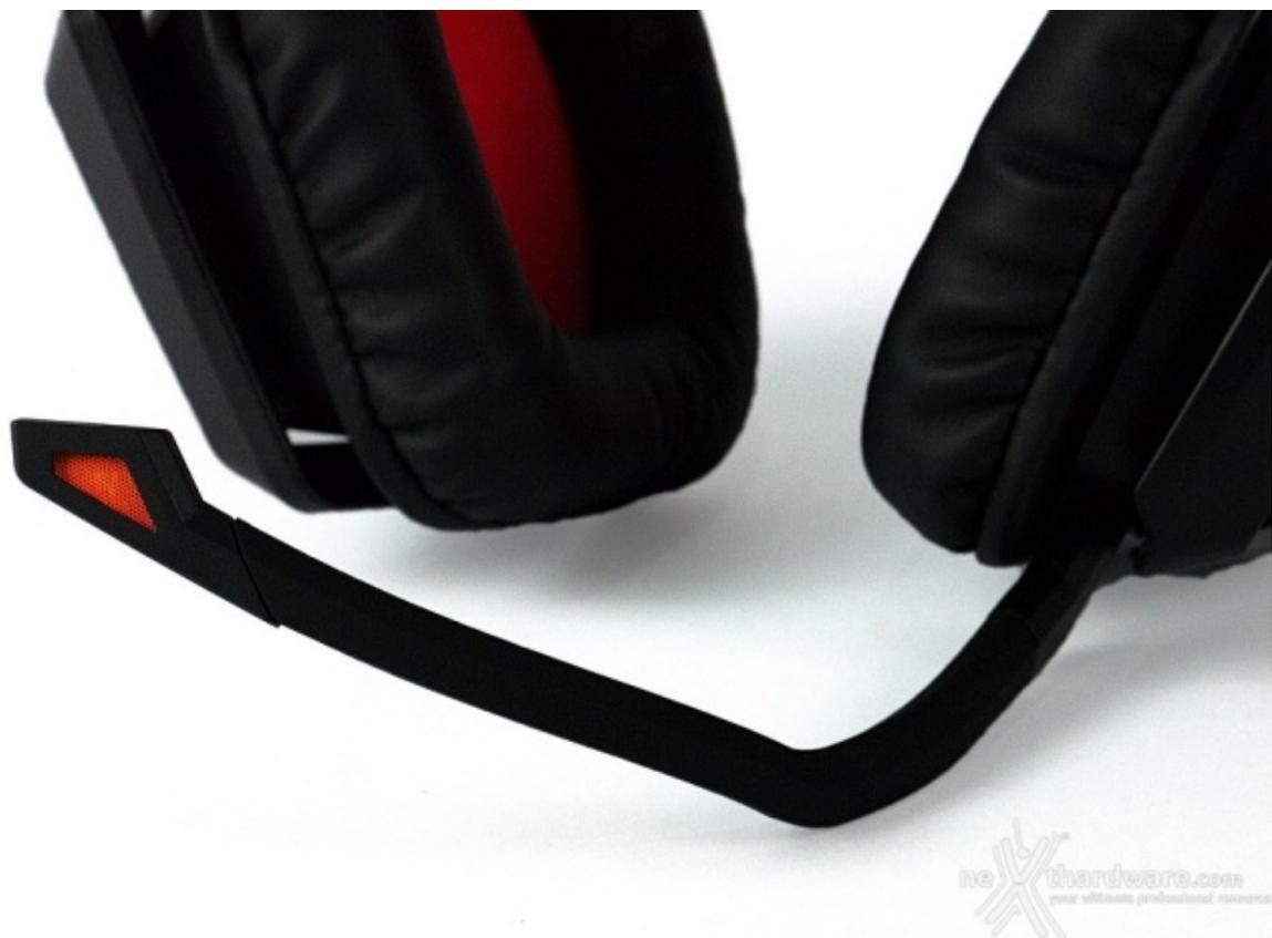
Il microfono, a pattern unidirezionale, è installato sul terminale di un'asta flessibile in gomma, in modo del tutto identico alle altre soluzioni STRIX.
