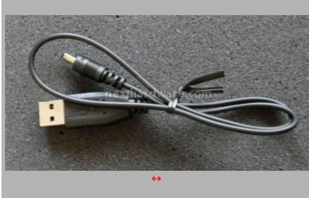
Il cavo di alimentazione è lungo 43 cm (escluso connettori) e permette di alimentare il Chill Mat da qualsiasi porta USB presente sul portatile.
