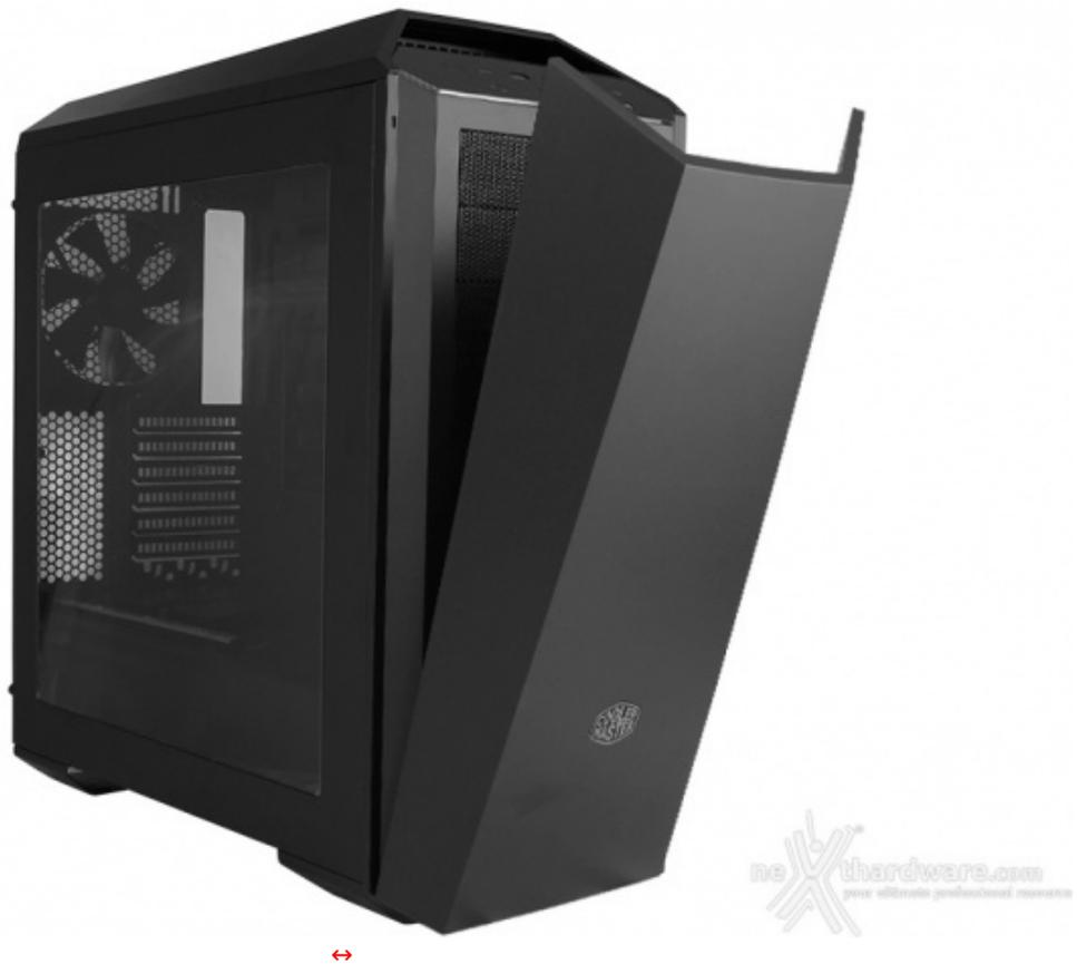
L'intero pannello può essere facilmente aperto nella parte superiore, una soluzione che potrebbe tornare utile qualora si volesse effettuare un controllo al volo su display o taniche inserite negli slot da 5,25", ma scomoda se avete ancora a che fare con i lettori ottici.
