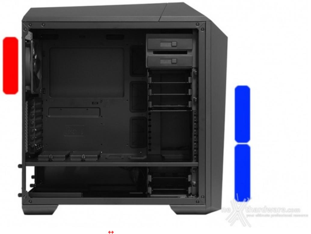
Il case è commercializzato con tre ventole da 140mm, di cui due posizionate frontalmente in immissione ed una posteriormente in estrazione.
