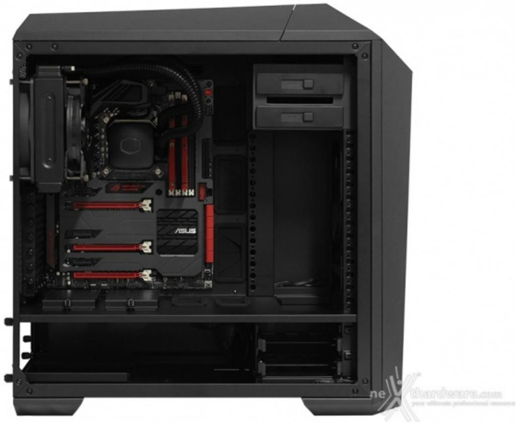
Data la sua configurazione push/pull, per poter usufruire a pieno delle sue potenzialità , evitando al contempo che andasse ad interferire con i dissipatori della scheda madre, abbiamo montato il nostro All-in-One nella parte posteriore del case.
