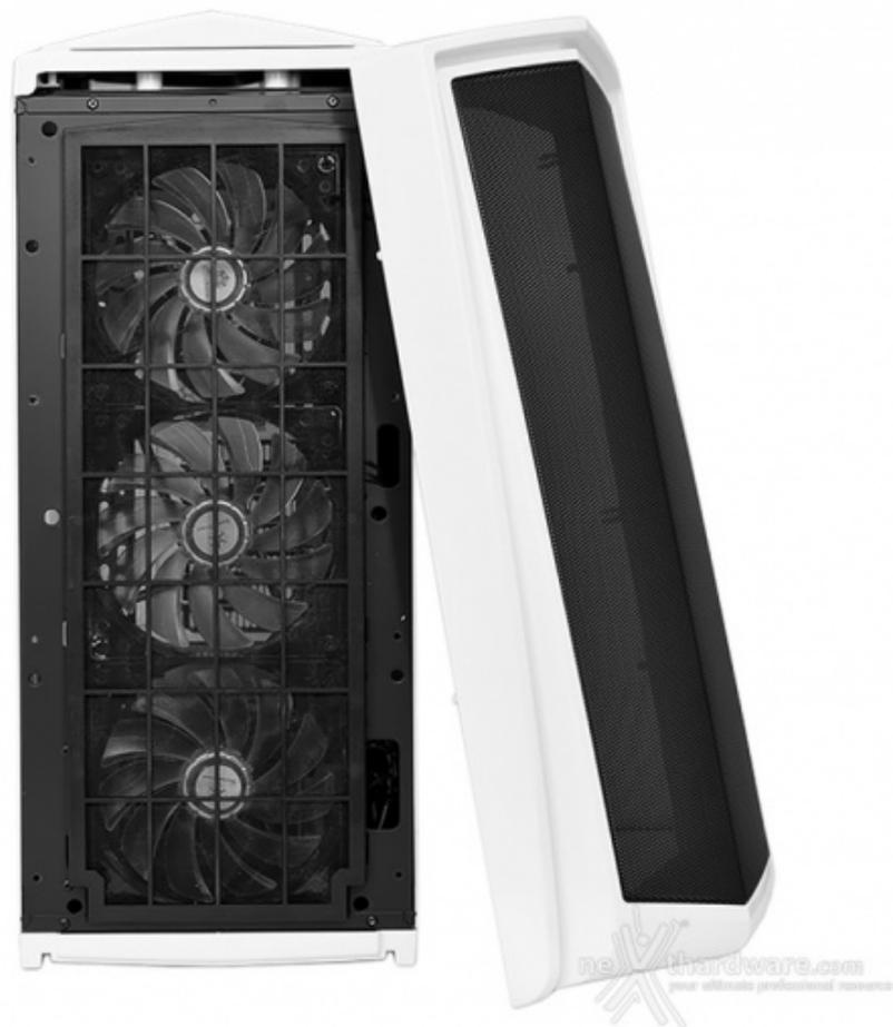
Se ciò non dovesse essere sufficiente a bloccare la polvere, rimuovendo il frontale avremo modo di accedere al vero e proprio filtro antipolvere posto a protezione delle tre ventole appena menzionate.
