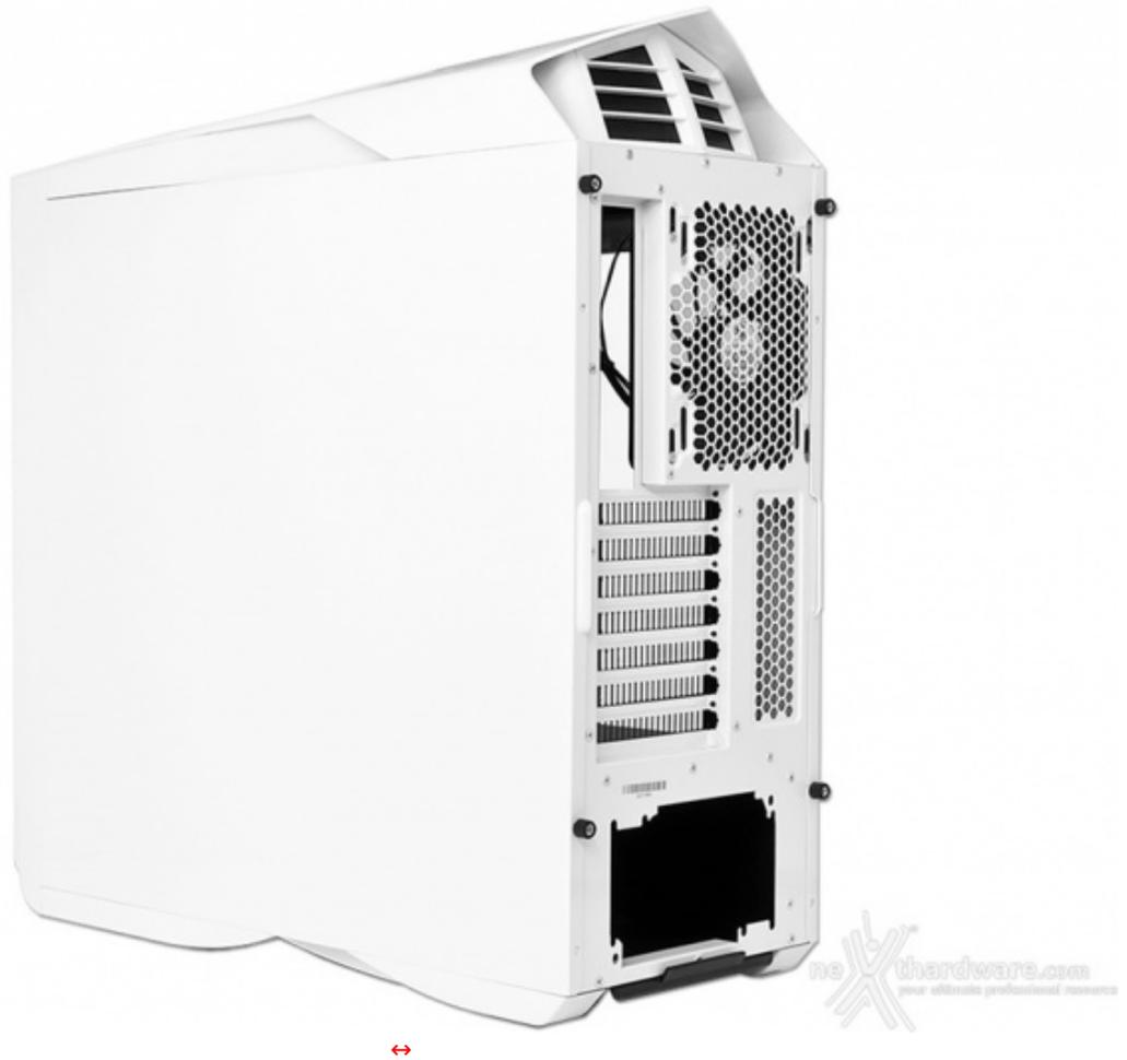
La struttura portante, così come i due pannelli laterali, sono realizzati in acciaio SECC verniciato di colore bianco.
