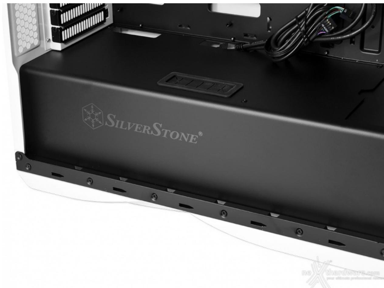
La copertura anteriore, non removibile, è realizzata in acciaio e fissata saldamente alla struttura tramite dei rivetti.
