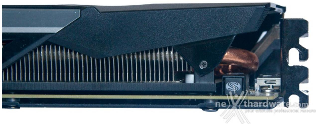
Nel particolare in alto è visibile lo switch per il passaggio tra i due BIOS presenti: nessuna modifica alle frequenze di lavoro, ma solo parametri più elevati di assorbimento energetico e temperatura massima di esercizio della GPU.
