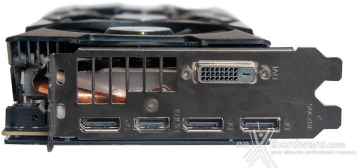
E chiudiamo con la dotazione di uscite video che, come per la Fury X, conta tre DisplayPort 1.2a compatibili anche con lo standard eDP 1.4 ed una HDMI 1.4a.
