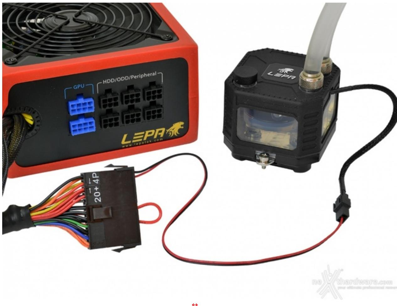
È caldamente consigliato di eseguire entrambe le operazioni al di fuori del case utilizzando l'adattatore 24 -> 3 pin fornito a corredo, tramite il quale sarà possibile alimentare la pompa senza dover necessariamente avviare il sistema.
