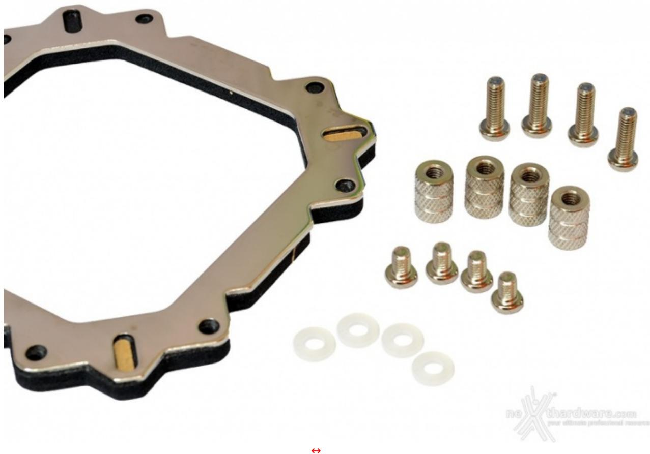
Una volta selezionato tutto il necessario, si dovrà predisporre il backplate per il montaggio sul socket aiutandoci con le indicazioni presenti sul manuale d'uso ed inserendo le quattro viti lunghe nei rispettivi alloggi.
