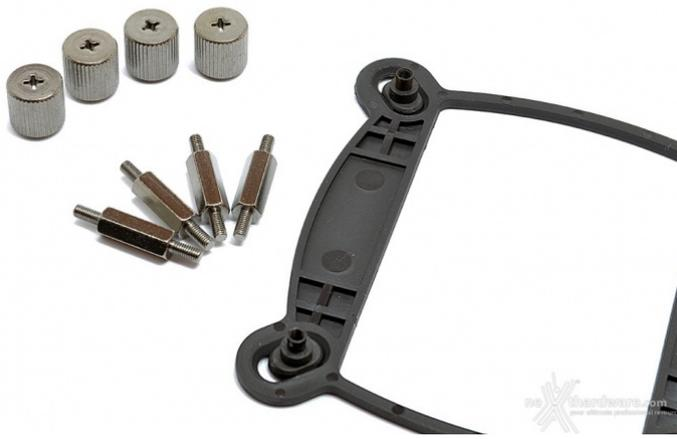
Per quanto riguarda il socket in questione dovremo spostare i dadi filettati del backplate nella parte interna della sede preposta e scegliere il set di viti corrispondenti, ovvero di tipo lungo (per socket 115x e 1366).
