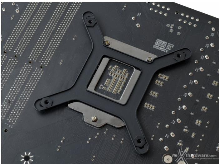
Una volta predisposti i dadi filettati per l'installazione sul socket a nostra disposizione, nel nostro caso in posizione interna, andremo a collocare il backplate nella parte posteriore della scheda madre.
