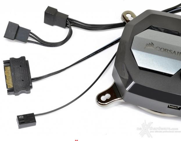
L'alimentazione di tutti i modelli visti finora è affidata ad un connettore SATA POWER che si occuperà di garantire i 12V necessari al corretto funzionamento della pompa, del LED RGB e delle due ventole fornite a corredo se collegate allo sdoppiatore incluso. Il connettore a 3 pin tachimetrico dovrà essere inserito nel CPU FAN della scheda madre per visualizzare la velocità della pompa. Facciamo presente, inoltre, che per gestire la velocità delle ventole tramite il software Corsair LINK
