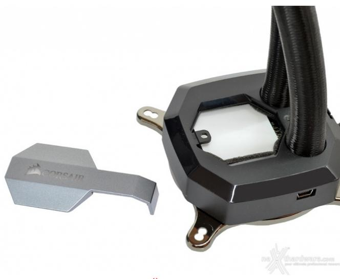
I tre modelli dotati di waterblock a design ottagonale dispongono di cover intercambiabili dando la possibilità di sostituire quelle in plastica grigia che troviamo di serie con altre di diverse colorazioni.
